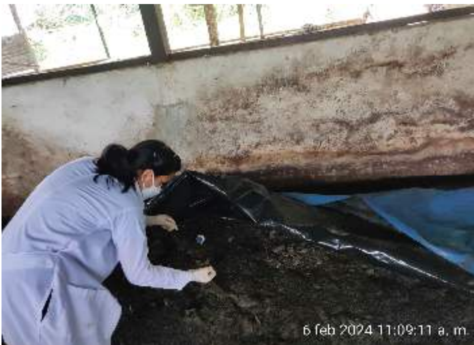
Figura 45. Medición de temperatura de cada una de las camas composteras.
