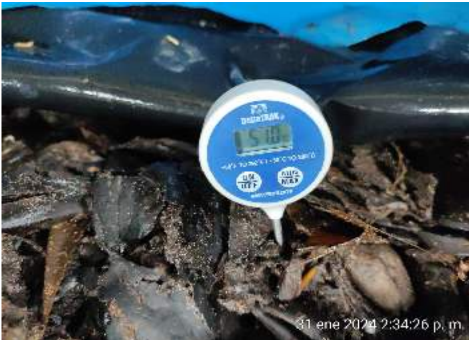
Figura 46. Temperatura de los residuos sólidos orgánicos en su proceso de descomposición.
