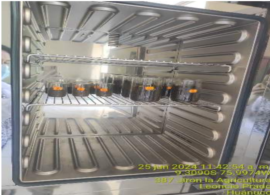
Figura 56. Muestras colocadas en el horno a 105°C por 24 horas.
