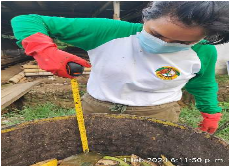
Figura 34. Medición de altura libre del cilindro para la el calculo de la densidad
