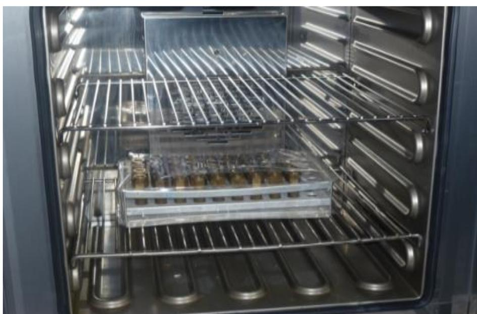
Figura 6. Calibración de los tubos de permeación de hexafluoruro de azufre.
