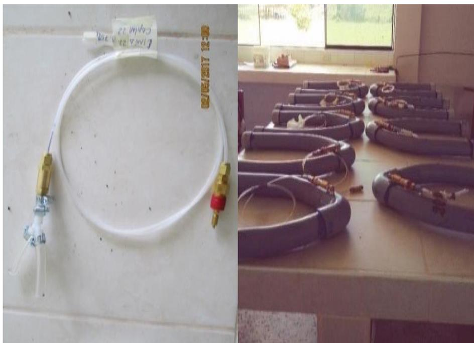
Figura 4. Calibración de líneas de flujo.
