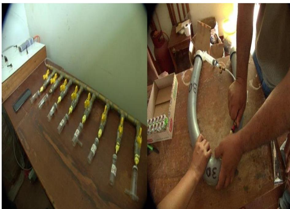
Figura 9. Sistema de vacío para viales y colecta de gases
