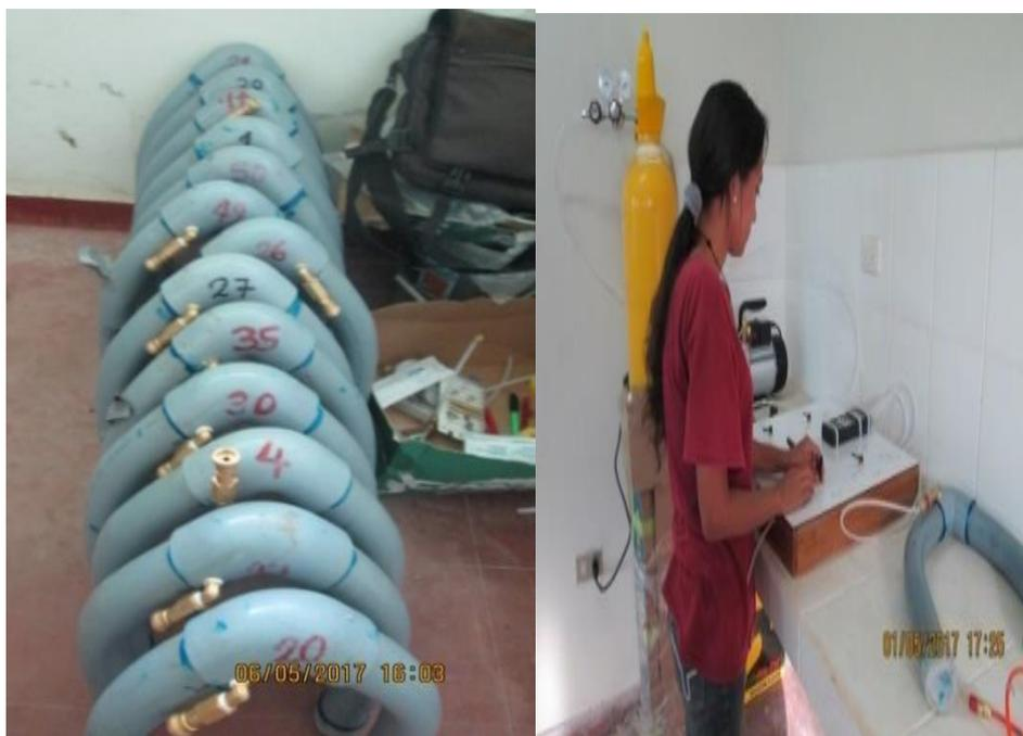
Figura 2. Calibración de tanques de colección tipo yugo.
