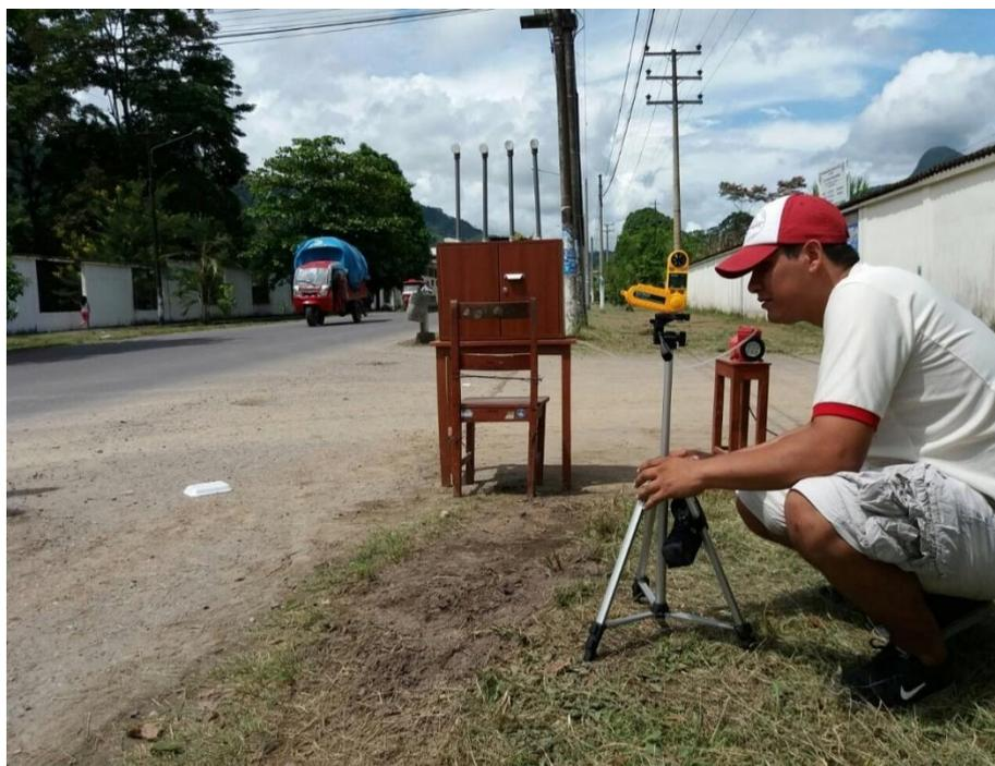
Figura 55. Medición de la velocidad y dirección del viento en el primer punto de muestreo.
