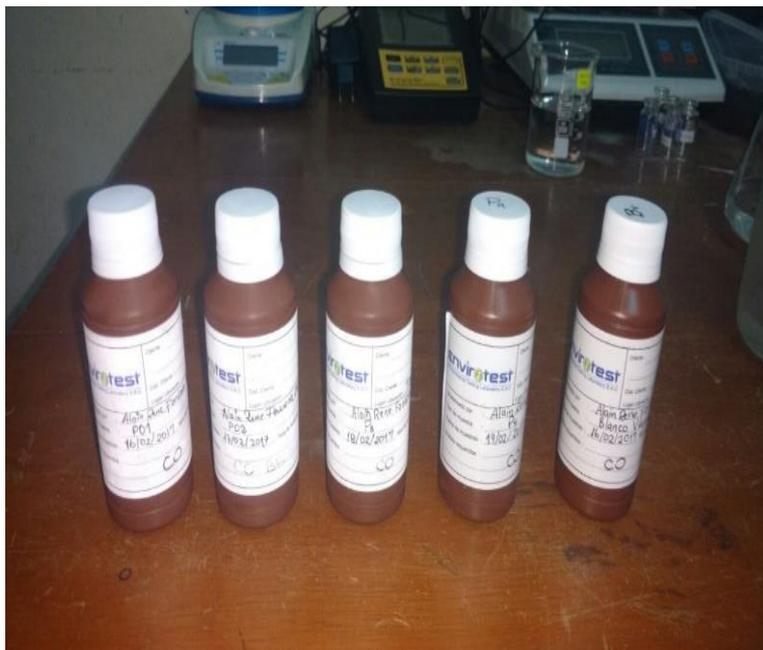
Figura 54. Muestras de monóxido de carbono de los puntos de muestreo.
