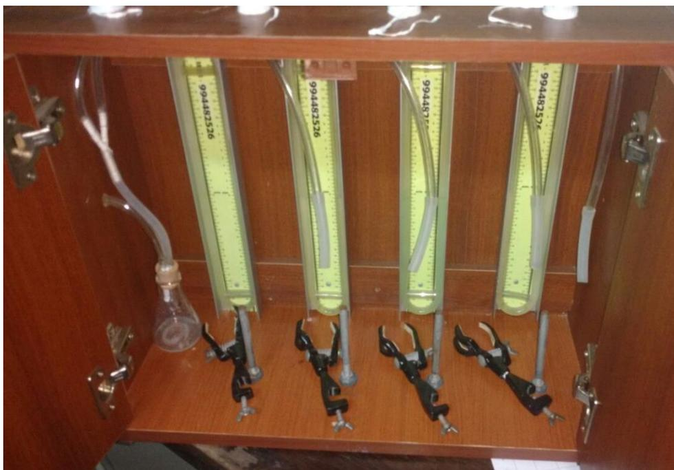
Figura 50. Calibración de los caudales del tren de muestreo.
