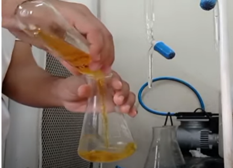
Figura 27. Preparación para la titulación de las muestras adicionando ferroína
