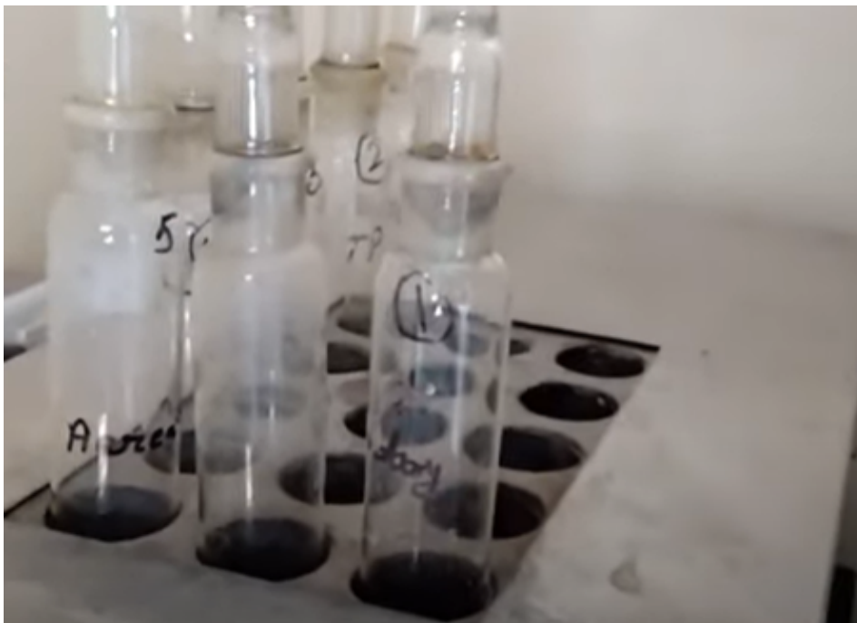
Figura 26. Digestión de las muestras para la determinación de la DQO
