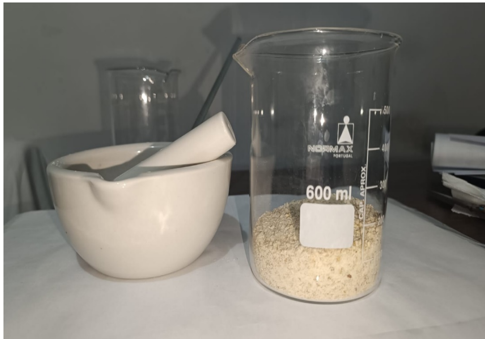
Figura 16. Semillas de moringa sin cáscara molidas en el mortero
