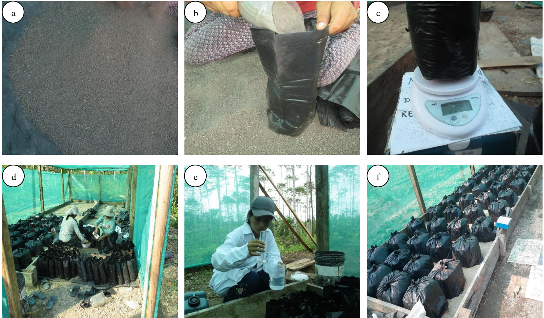
Figura 18. Preparación del sustrato: a. Suelo tamizado, b. Llenado de bolsas, c. Peso de bolsas con suelo, d. Llenado de bolsas y ordenado según croquis, e. Incorporación de cadmio en las bolsas y f. Incubación de cadmio en bolsas llenadas con suelo.
