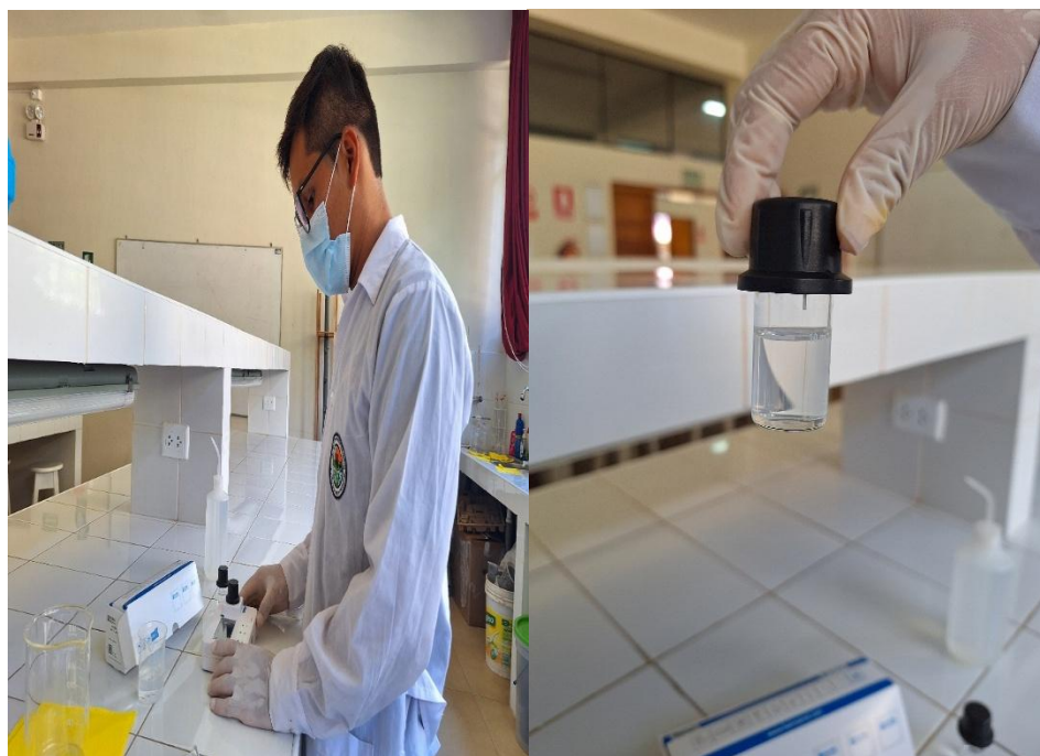
Figura 43. Medición de Sulfato en el Agua
