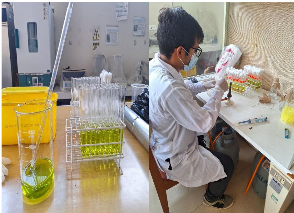
Figura 39. Preparación de caldos y sembrado de muestras
