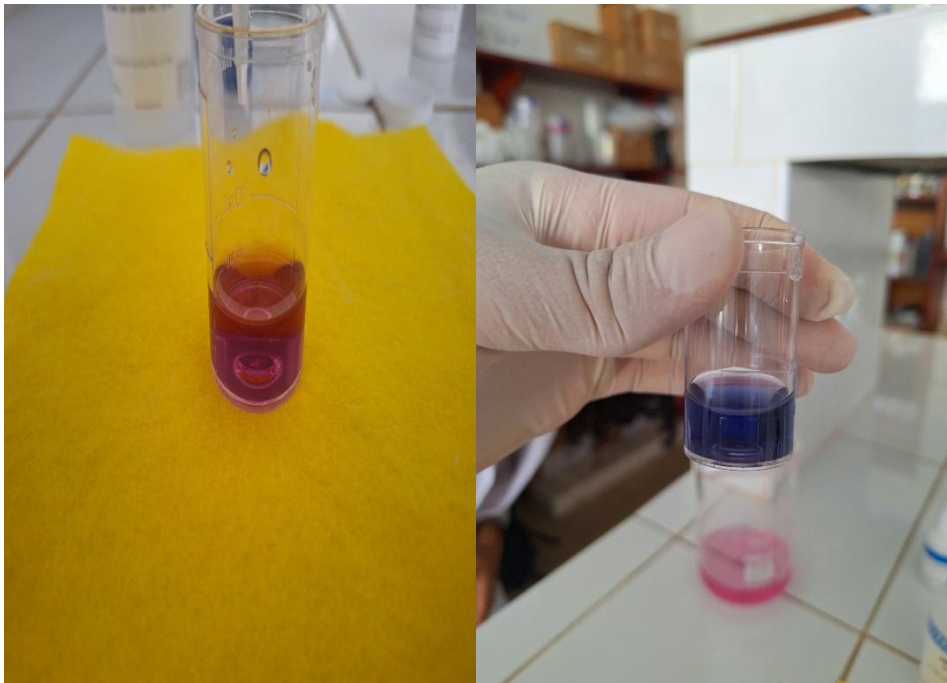
Figura 45. Determinación de Dureza en la muestra
