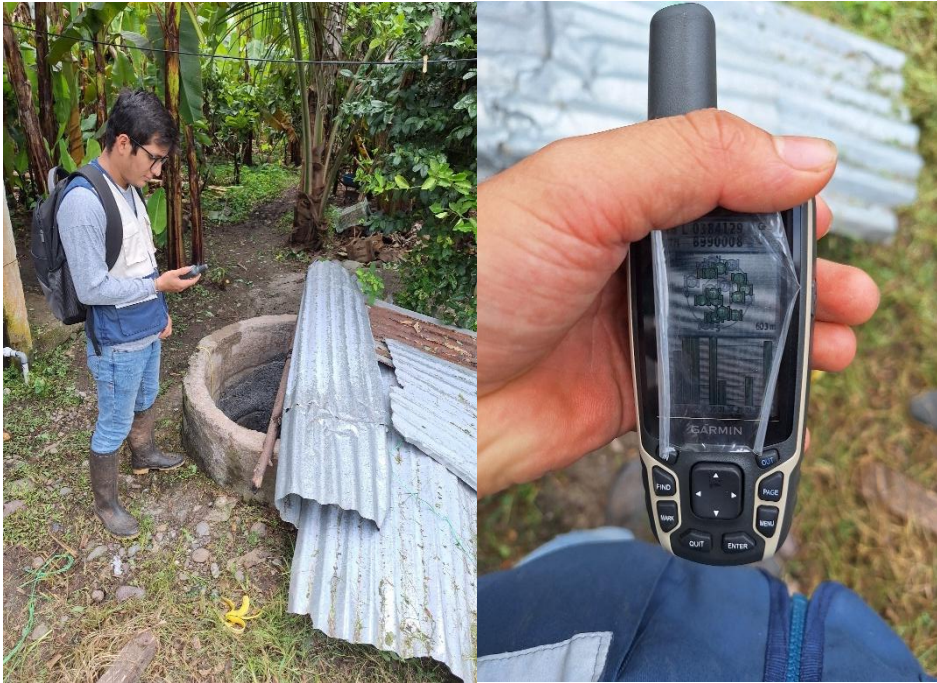
Figura 34. Toma de coordenadas en el punto SRGLP-01 con el GPS MAP
