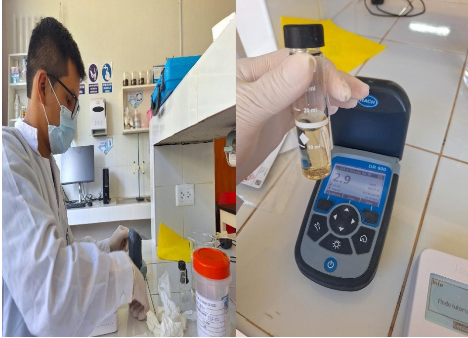
Figura 44. Medición de Nitrato en el Agua
