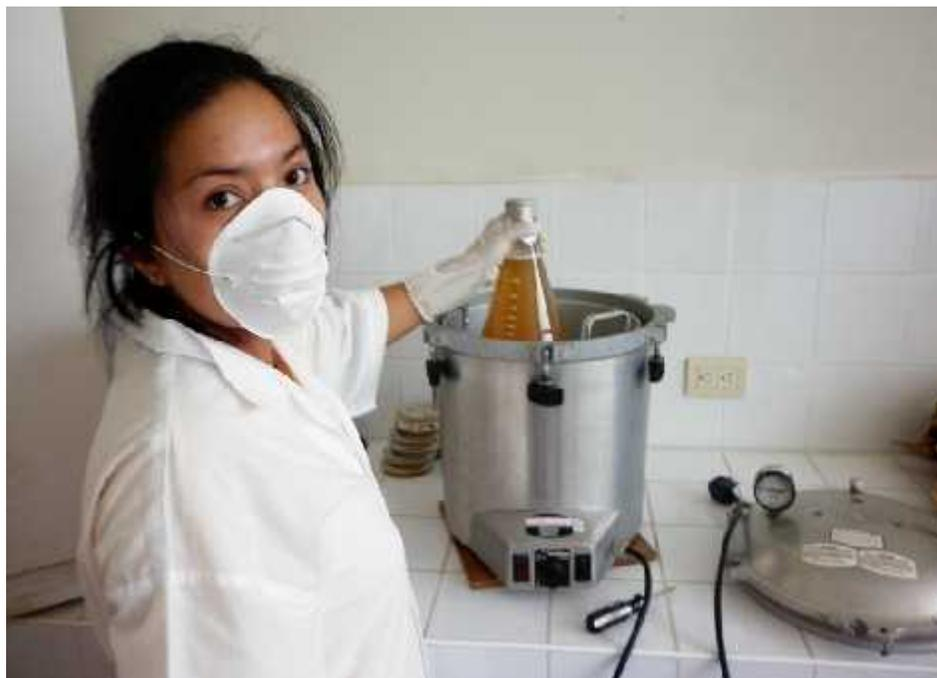
Figura 9. Esterilización por autoclavado de medio de cultivo
