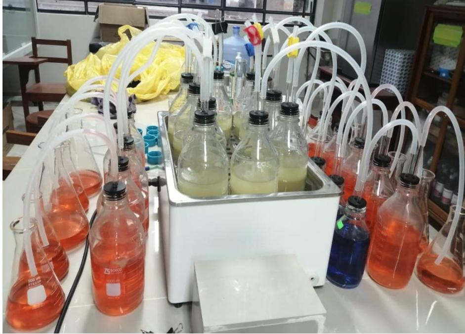
Figura 32. Tratamiento testigo en funcionamiento
