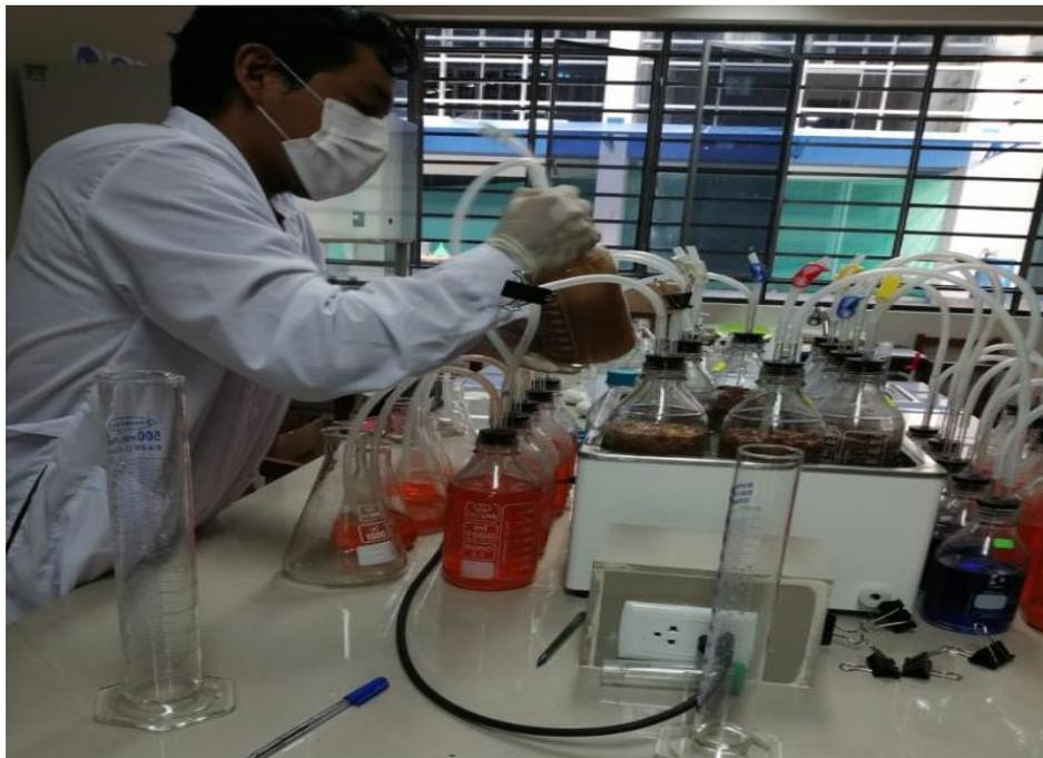
Figura 35. Agitación previo a la medición de los volúmenes producidos
