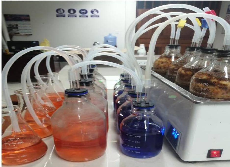
Figura 34. Sistema de medición para el metano
