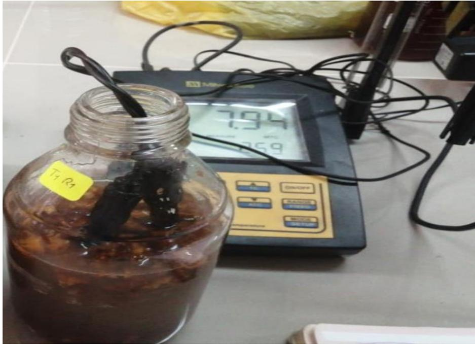
Figura 30. Estabilización de pH en cada uno de los biorreactores
