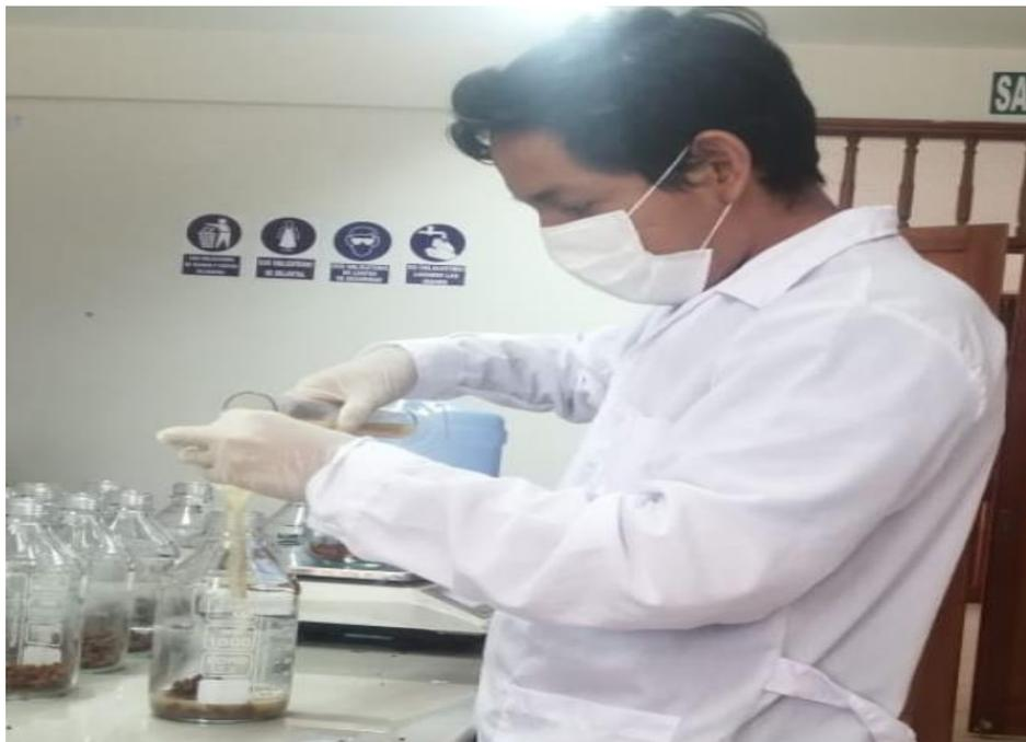
Figura 27. Insertamiento de la carga microbiana en las botellas
