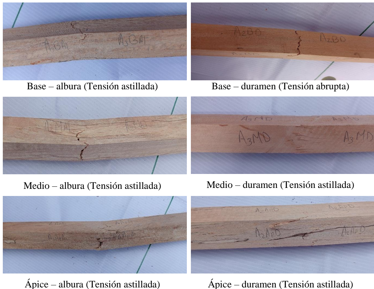
Figura 13. Fallas generadas después del ensayo de flexión estática
