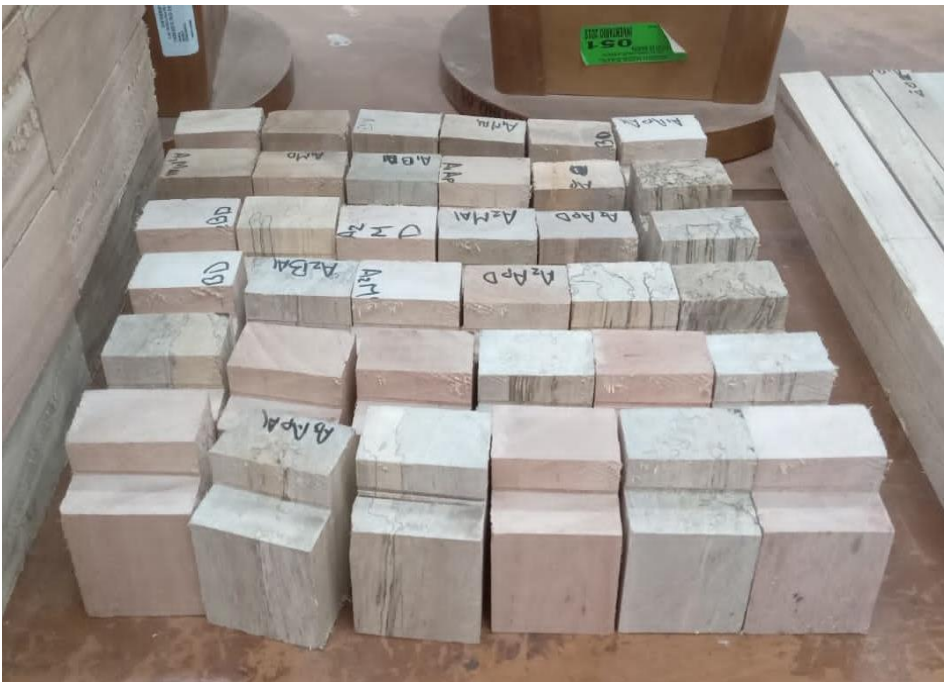
Figura 30. Probetas para ensayo de cizallamiento
