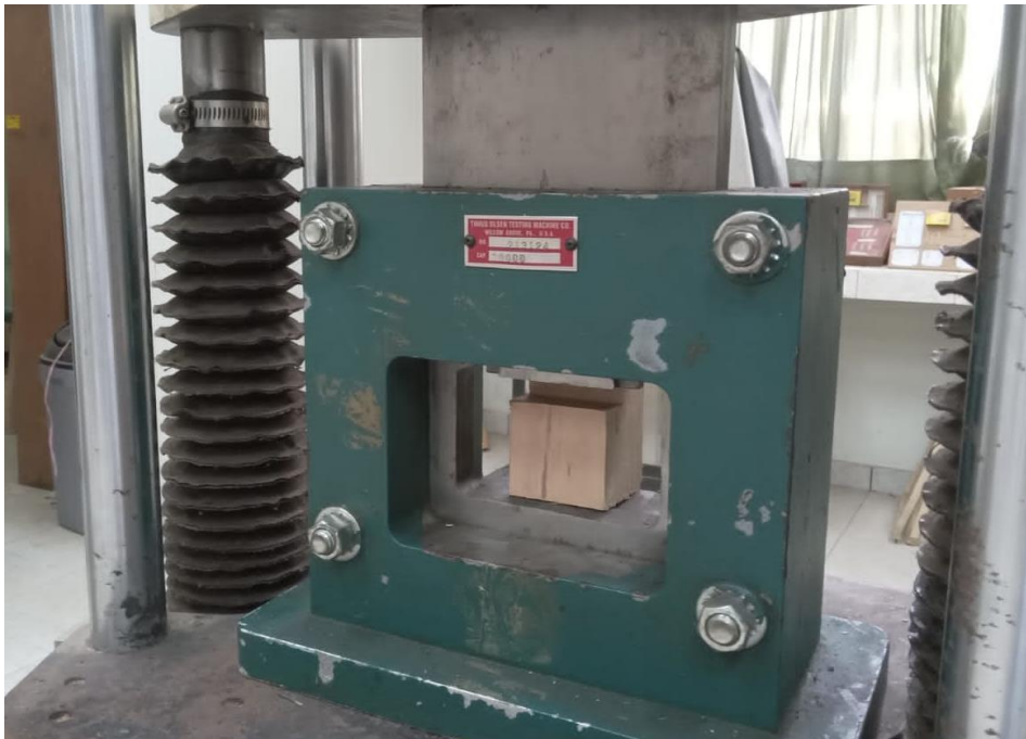
Figura 32. Ensayo de cizallamiento
