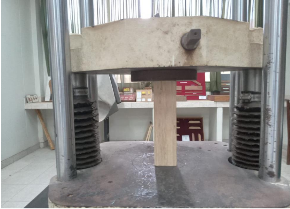
Figura 33. Ensayo de compresión paralela a las fibras
