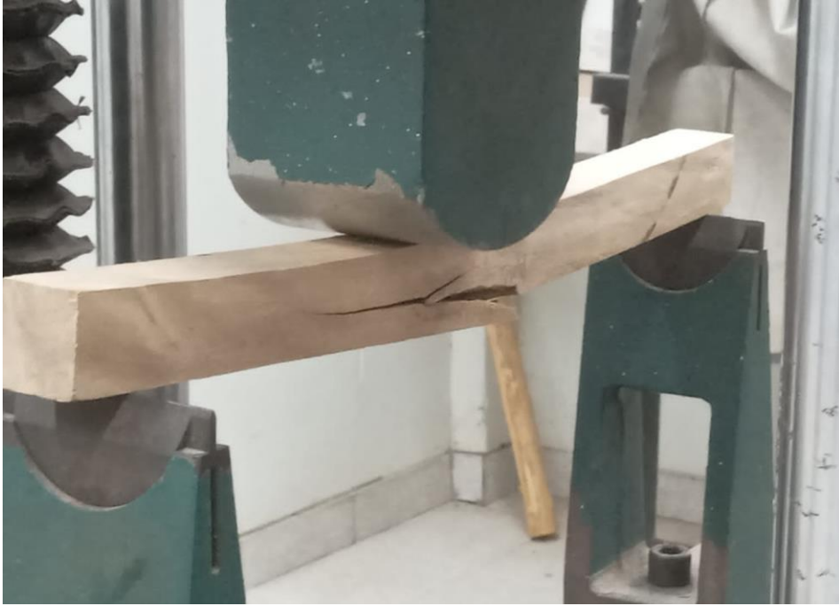
Figura 31. Ensayo de flexión estática
