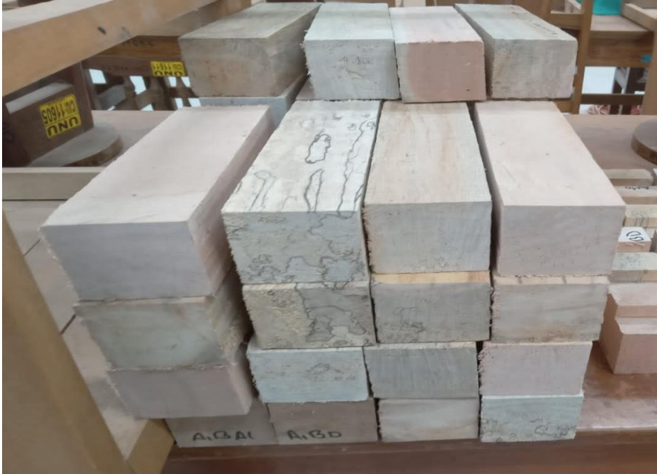
Figura 29. Probetas para ensayo de compresión paralela a las fibras
