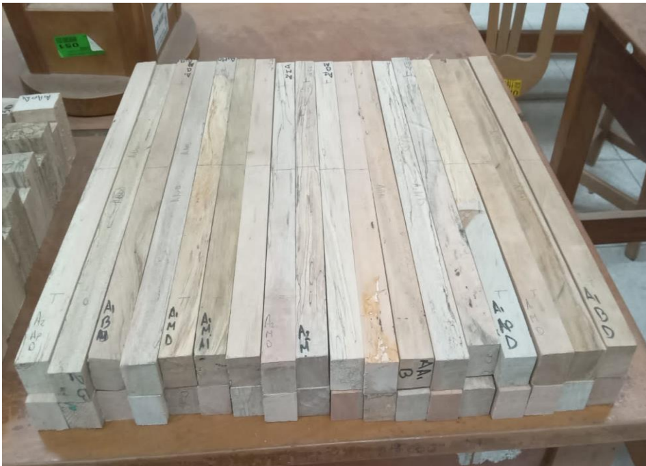
Figura 28. Probetas para ensayo de flexión estática
