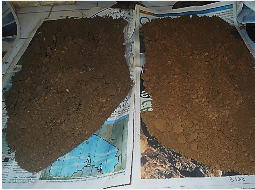
Figura 26. Los dos sustratos “suelo 0 a 20 y 20 a 40 cm”, secados y separados para su análisis en el Laboratorio de Suelos de la UNAS.
