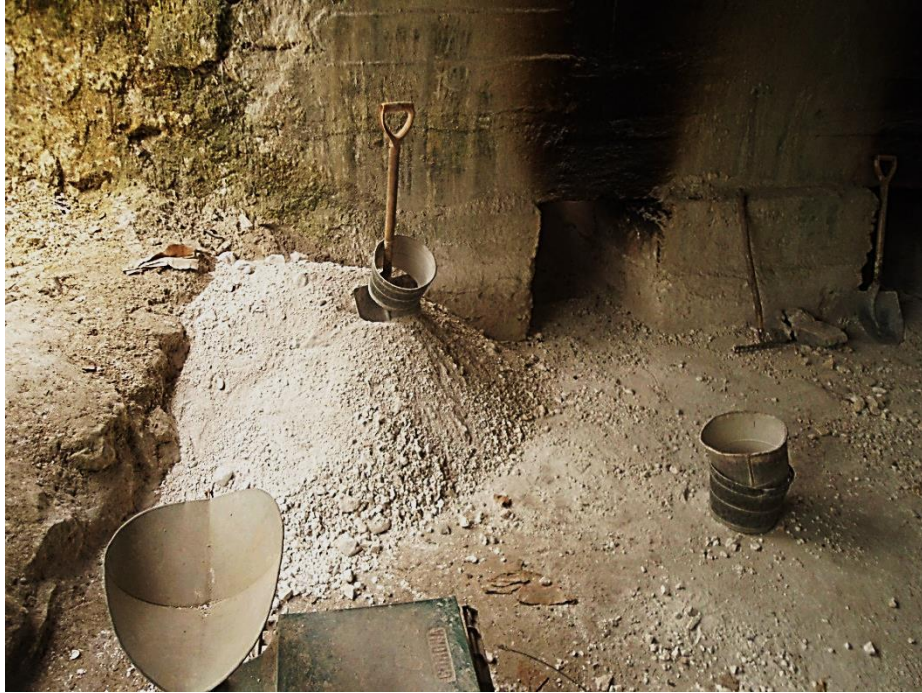
Figura 28. Horno de la Calería “José Luis”, sector Cueva de Las Pavas, Tingo María, donde se produce la cal mediante el quemado de la piedra caliza.
