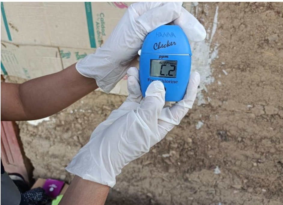
Figura 37. Muestreo de cloro residual en las tomas domiciliarias.
