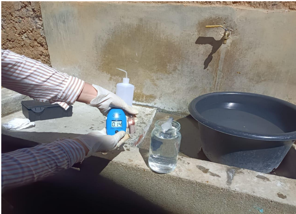
Figura 41. Medición del cloro residual en la red de distribución de agua potable.
