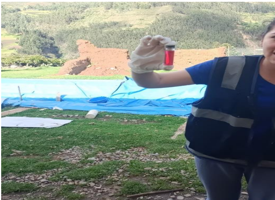
Figura 39. Coloración de una muestra tras añadir el reactivo DPD.
