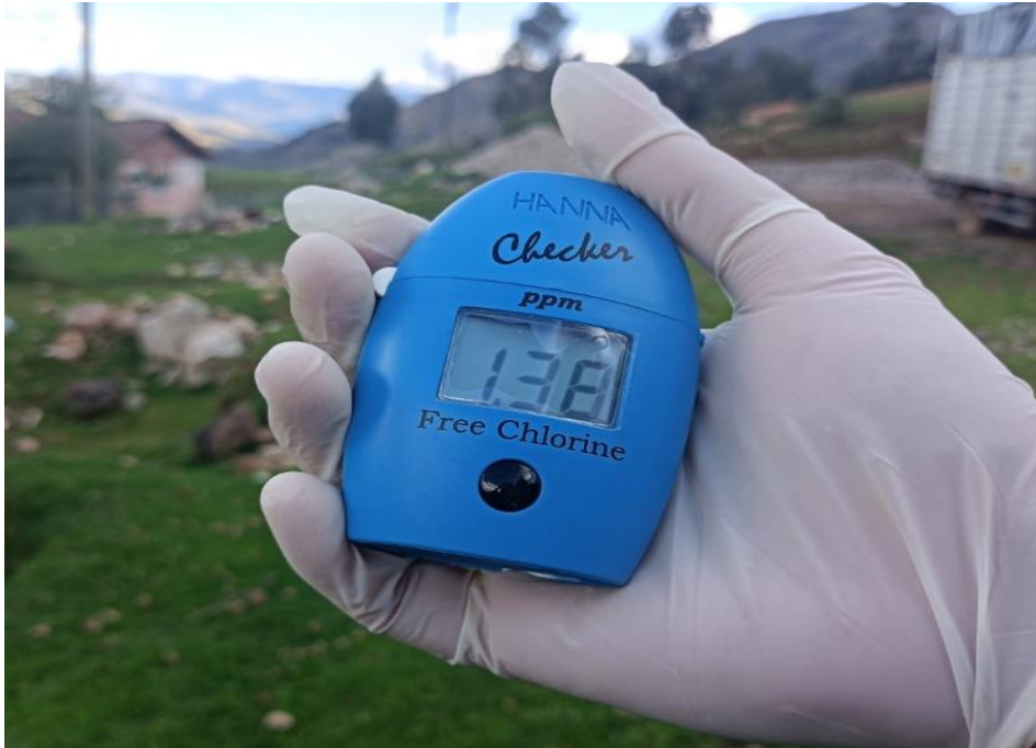
Figura 42. Medición de cloro residual en la vivienda N° 12 del Ramal 1.
