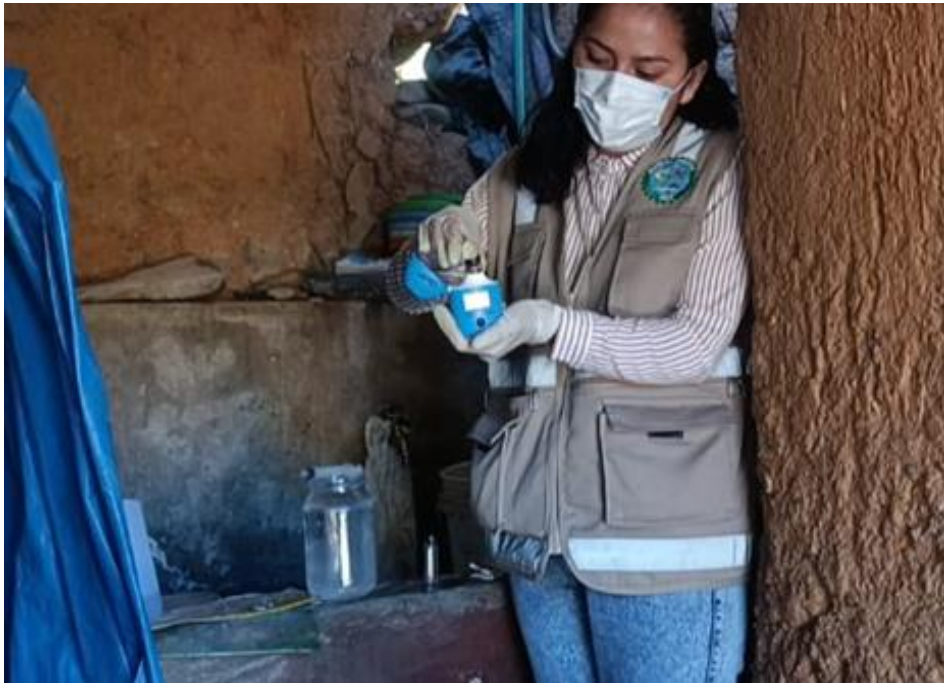
Figura 43. Medición de cloro residual en toma domiciliaria del Ramal 3.
