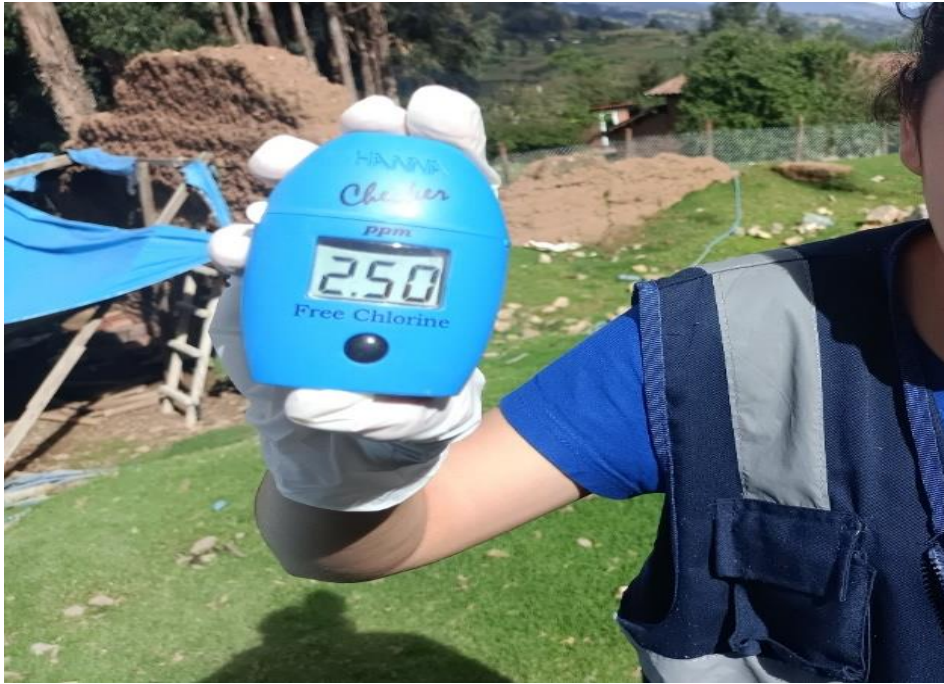
Figura 46. Medición de cloro residual en el reservorio
