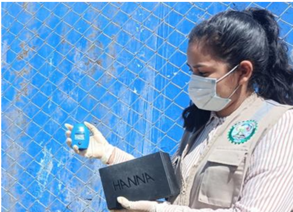
Figura 47. Ultima medición de cloro residual en el reservorio.
