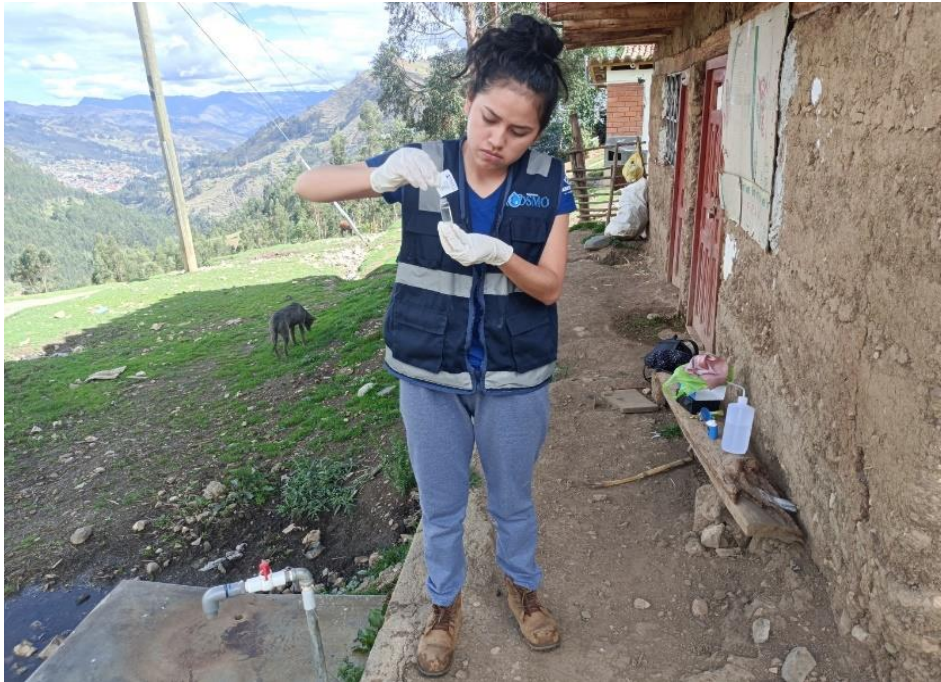
Figura 38. Adición de reactivo DPD para lectura de muestra.
