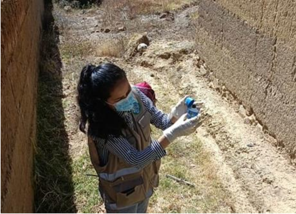
Figura 44. Medición de cloro residual en toma domiciliaria del Ramal 4.
