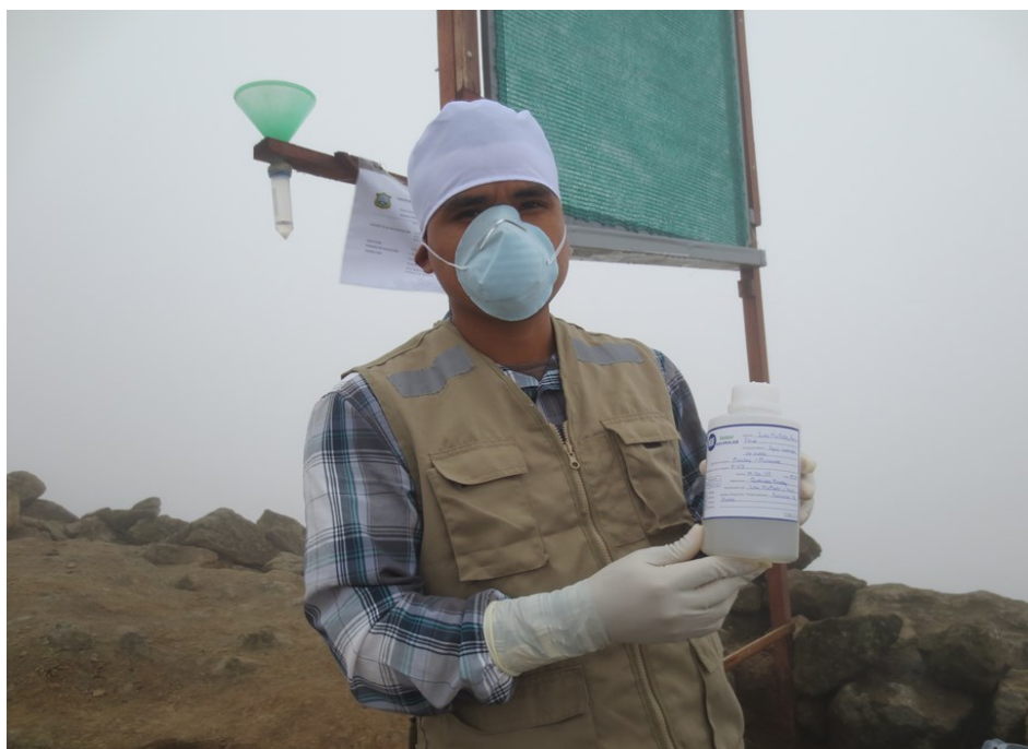
Figura 39. Frascos de plástico de 500 ml identificados correctamente el 22 de junio del 2017 que contienen agua de niebla para su análisis de concentración de plomo
