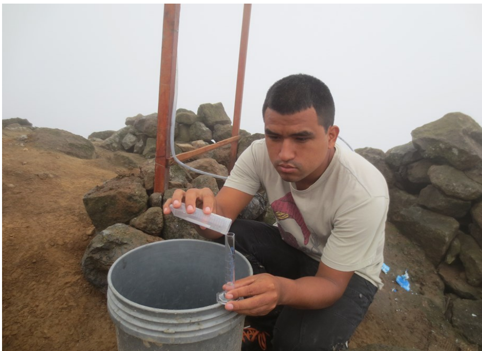
Figura 35. Medición realizada el 17 de junio del 2017 del volumen de agua colectado por el pluviómetro en el punto P-03
