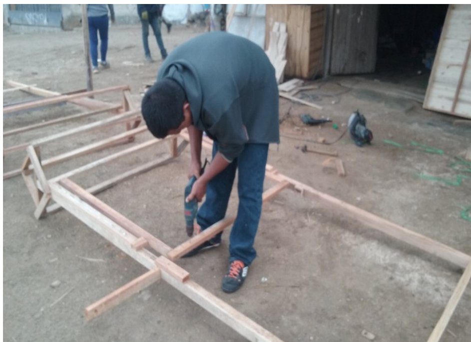
Figura 32. Armado de las estructuras base de los neblinómetros del 20 al 30 de mayo del 2017 en un taller de carpintería ubicado en AA.HH. Portada de Manchay I
