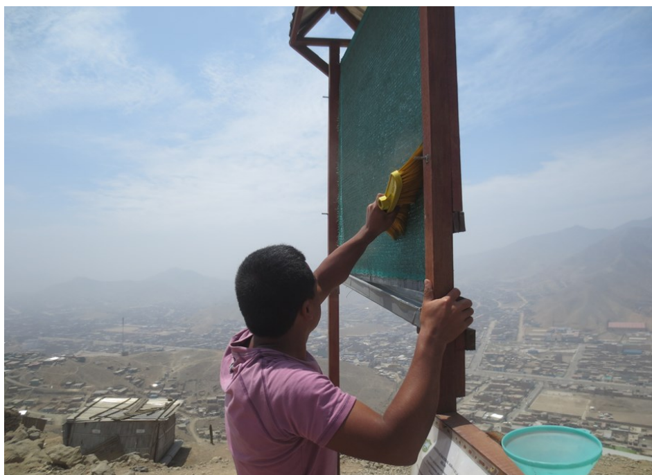
Figura 43. Mantenimiento con un escobillón de la malla raschel del neblinómetro en el punto P-01 realizado el 17 de siembre del 2017 (fue un día seco)
