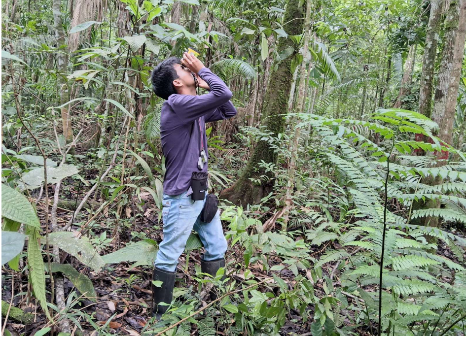
Figura 16. Estimación de la altura total de un árbol usando un telemetro Nikon Forestry pro II
