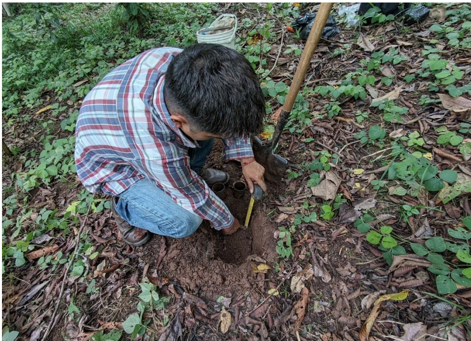
Figura 20. Extracción de suelo de 0 – 10 cm, 10 – 20 cm, para determinar la densidad aparente.
