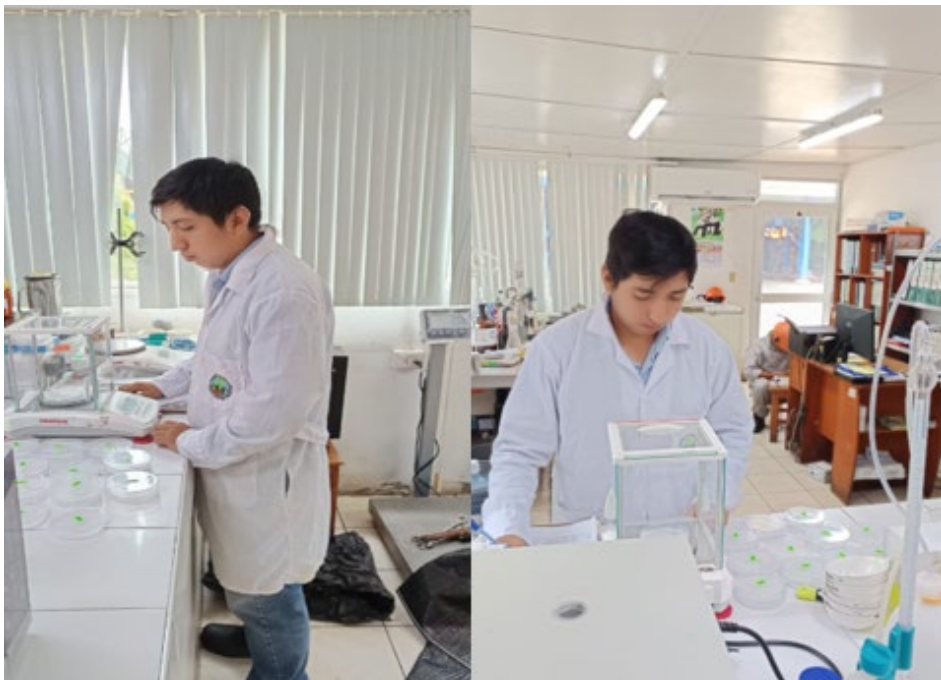
Figura 28. Pesado de las placas con vaselina (Peso inicial).
