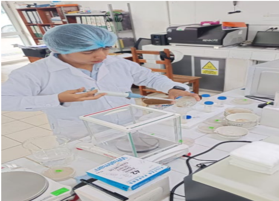
Figura 30. Lavado de placas con PAS para su análisis de plomo.
