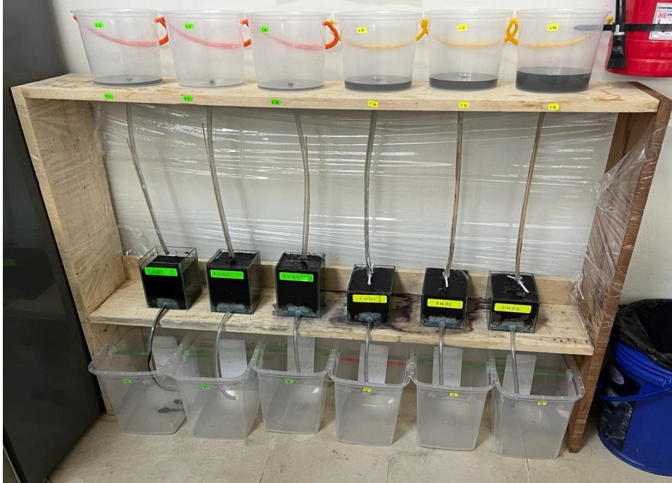
Figura 29. Sistema experimental con filtración vertical y horizontal
