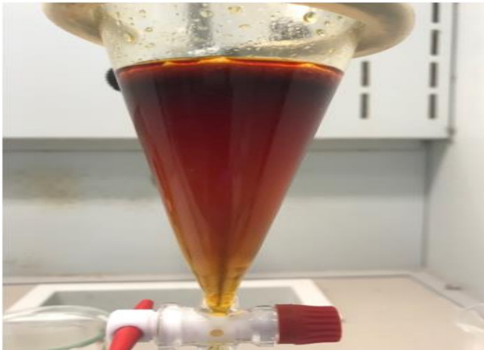
Figura 34. Separación de aceites y grasas para inicio de formación de fases
