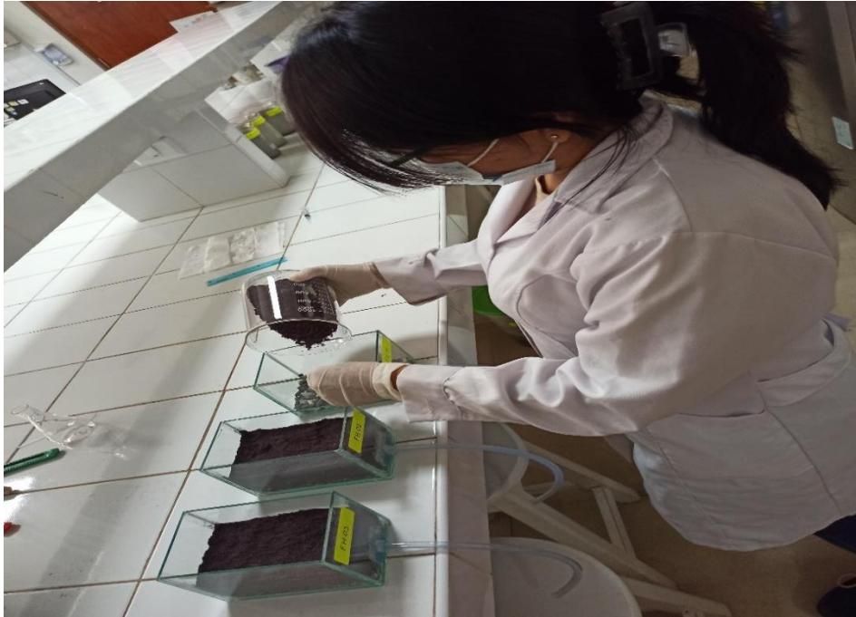
Figura 27. Preparación del filtro horizontal con el lecho filtrante
