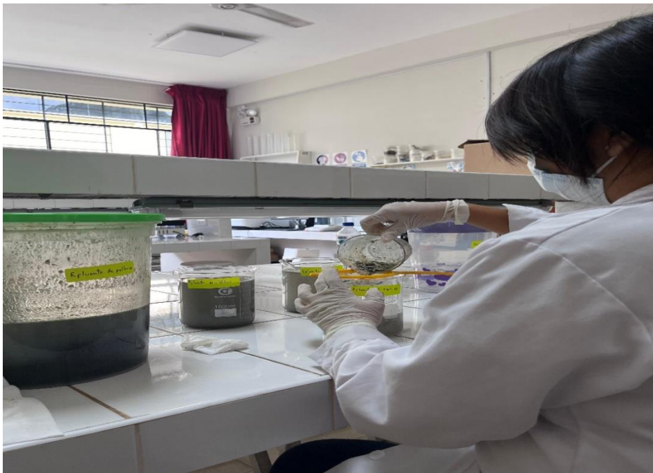
Figura 28. Preparación del efluente de poltería a diferentes diluciones
