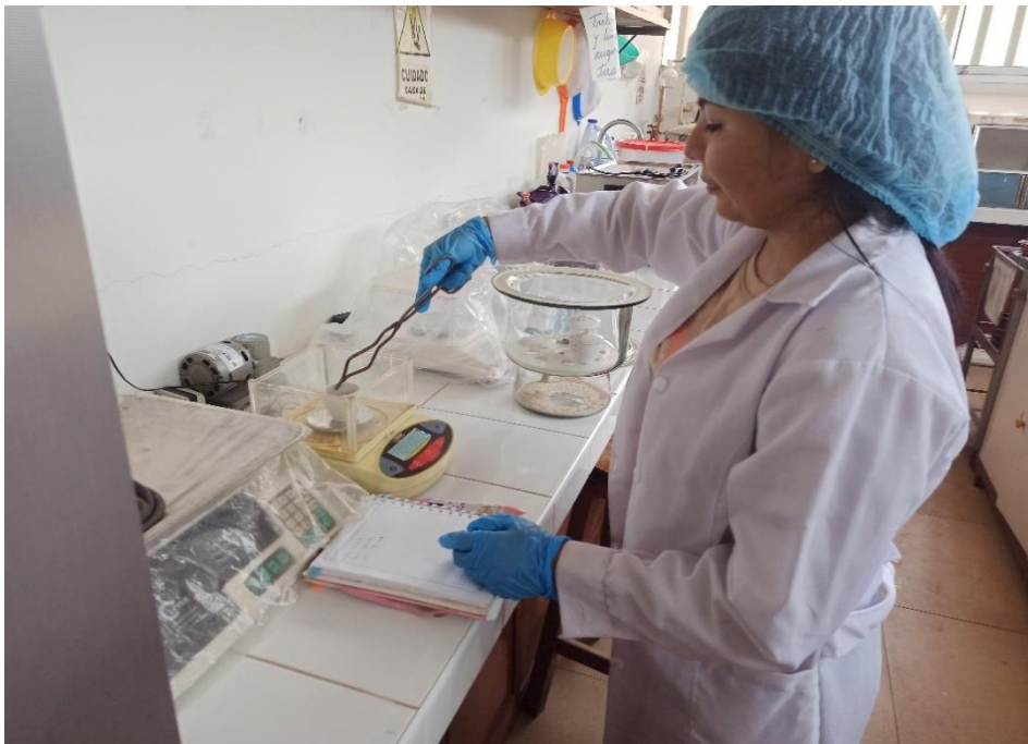
Figura 24. Pesado de los crisoles en la estufa para la determinación de las características fisicoquímicas básicas del efluente de la investigación (Sólidos Totales)
