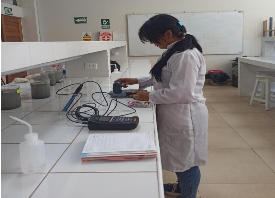
Figura 25. Determinación de las características fisicoquímicas básicas del efluente de la investigación (pH, Temperatura, Sólidos Totales)
