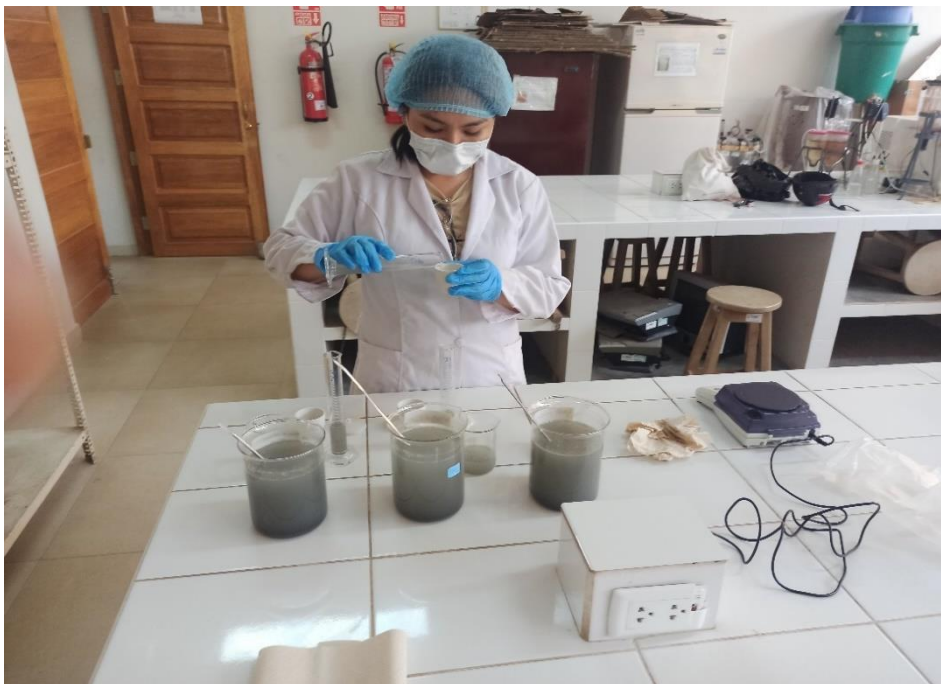
Figura 22. Determinación de las características fisicoquímicas básicas del efluente de la investigación (Sólidos Totales)
