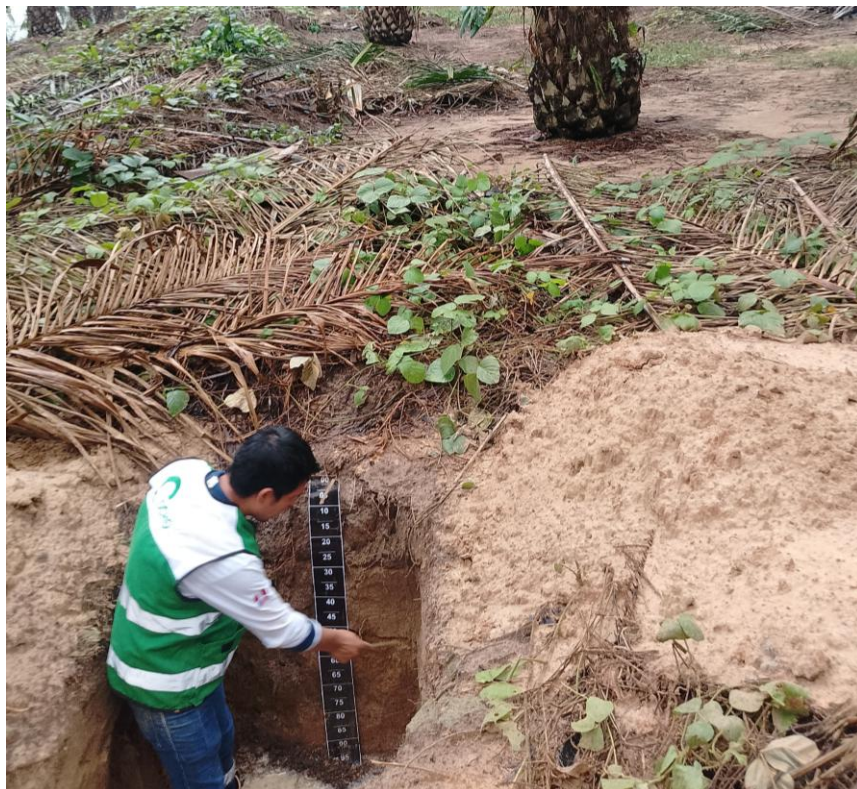
Figura 11. Identificación de Horizontes en el perfil modal del suelo
