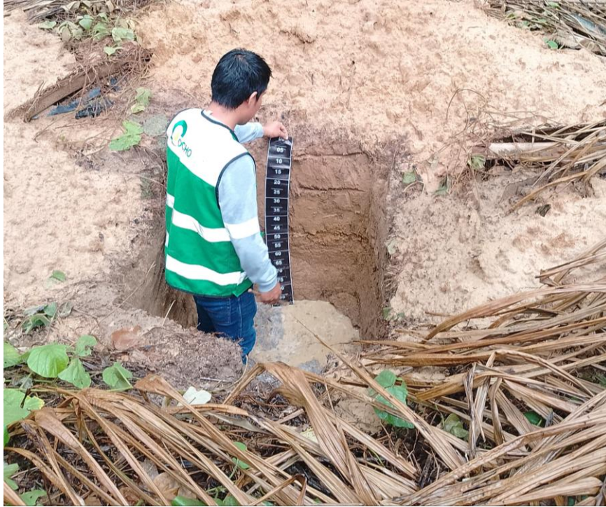
Figura 12. Medición de la profundidad de cada horizonte en el perfil modal del suelo
