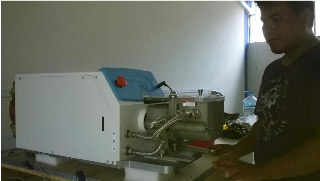
Figura 87. Proceso para la prueba farinográficos de las variedades (“Super chola” y “Perricholi”) de papa.
