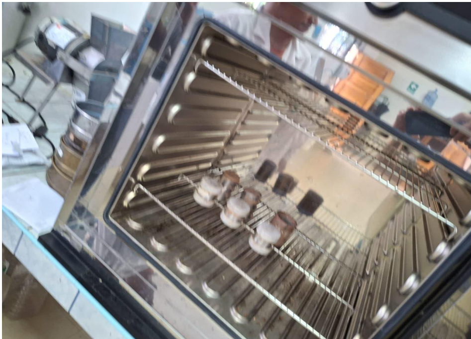
Figura 19. Secado de las muestras de los cilindros en una estufa el laboratorio de suelos.
