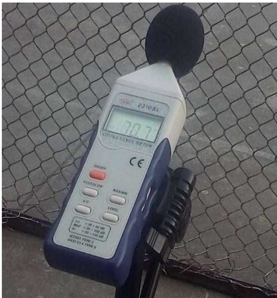
Figura 16. Equipo sonómetro marca SEW, modelo 2310 SL, Tipo II, serie 01619381
