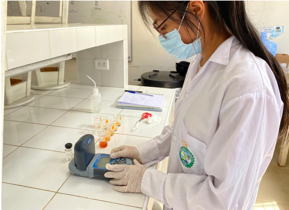
Figura 22. Medición de hierro
