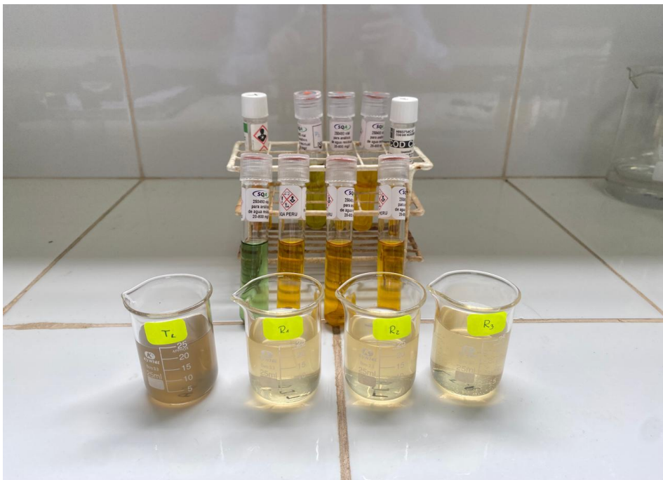
Figura 21. Muestra inicial y muestras finales de DQO.
