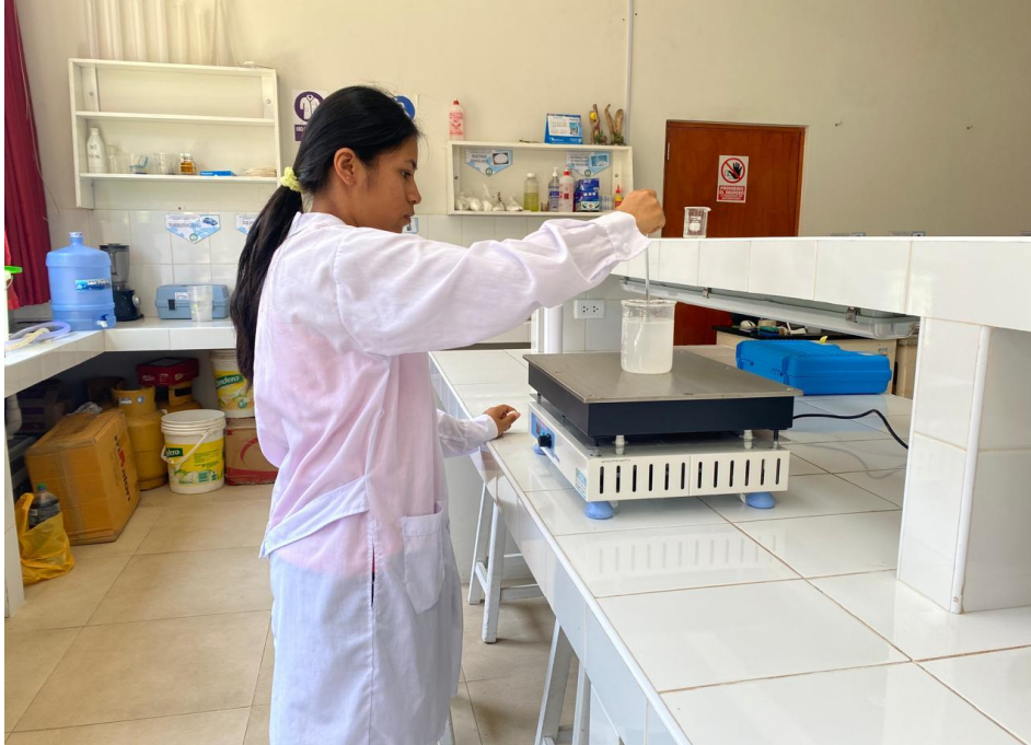
Figura 16. Elaboración de floculante de almidón de papa gelatinizado.
