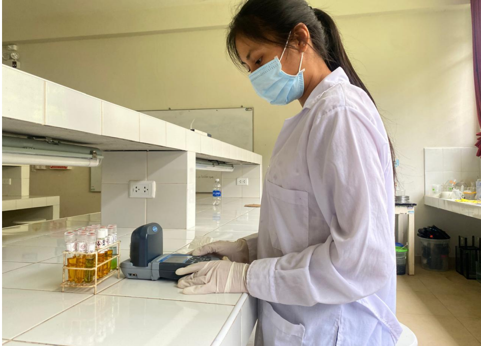
Figura 20. Medición de DQO final
