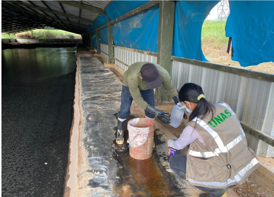
Figura 10. Recolección de muestras de lixiviado de la celda transitoria.
