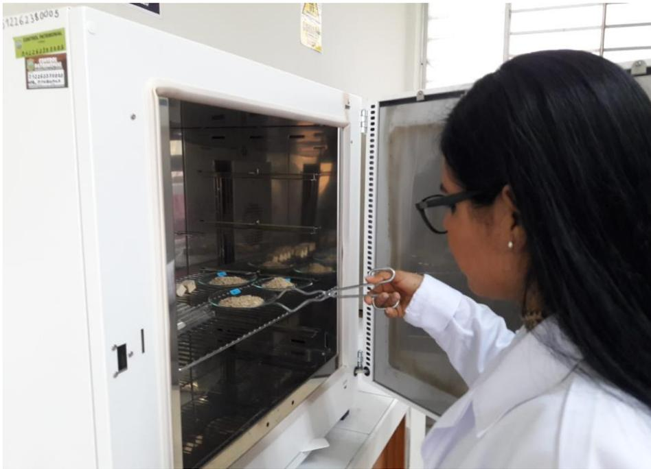
Figura 12. Colocado de muestras a la estufa para determinación de contenido de humedad.
