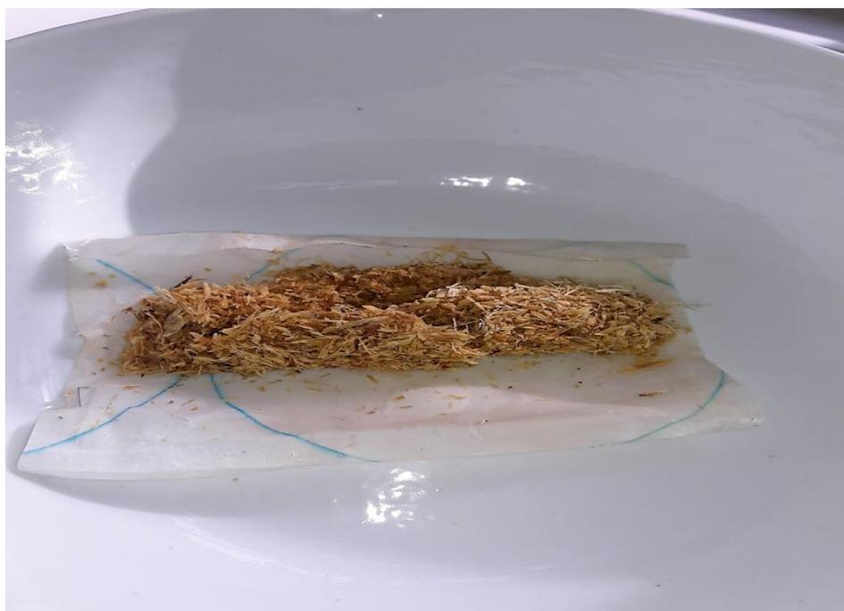
Figura 17. Muestra de residuo lignocelulósico después de extracción a reflujo.
