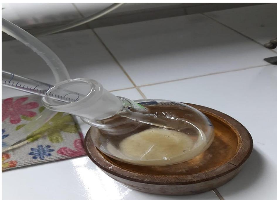
Figura 19. Retiro del sobrenadante para determinación de celulosa.
