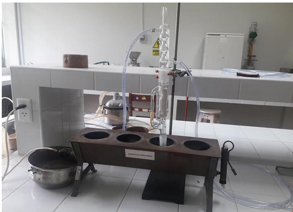
Figura 16. Instalación de equipo Soxhlet para determinación de extractivos
