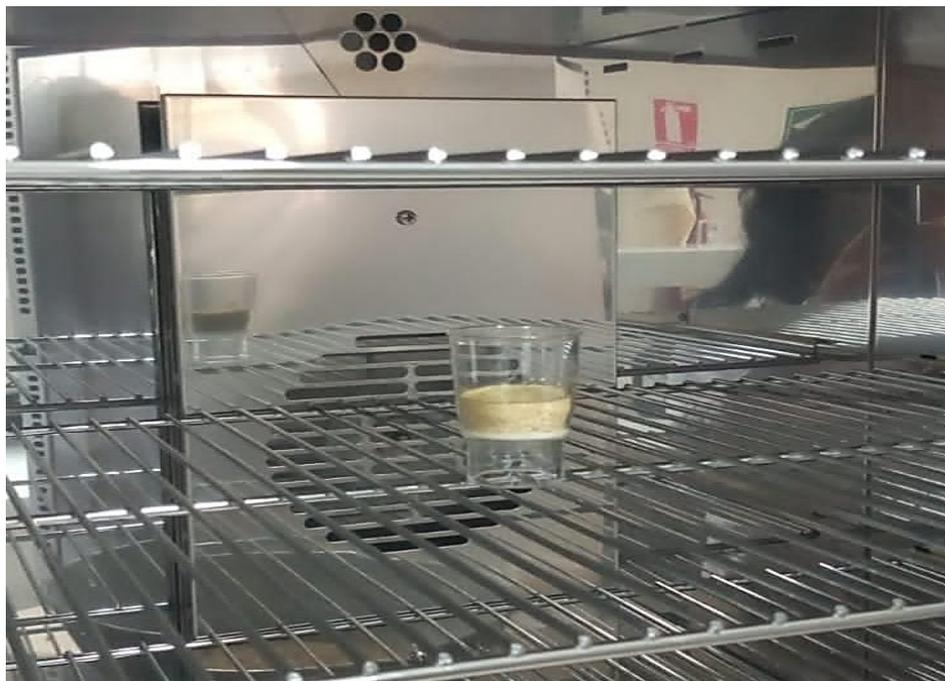
Figura 21. Muestra en estufa para determinación de celulosa.
