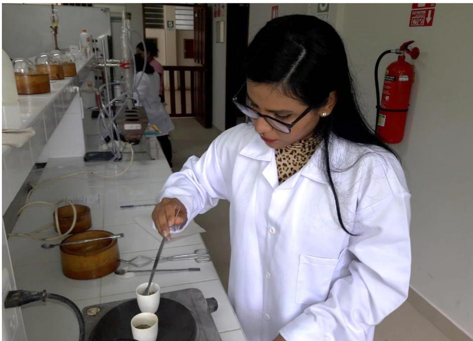
Figura 14. Calcinado de muestra para determinación de cenizas
