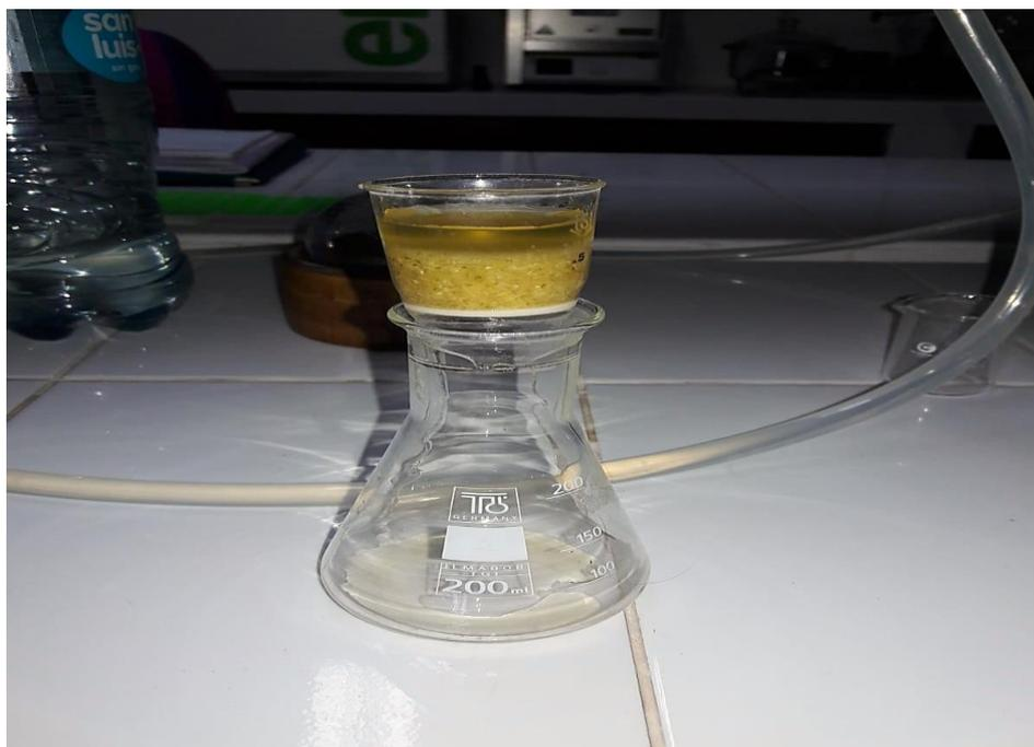
Figura 20. Filtrado de muestra con agua desionizada para determinar celulosa
