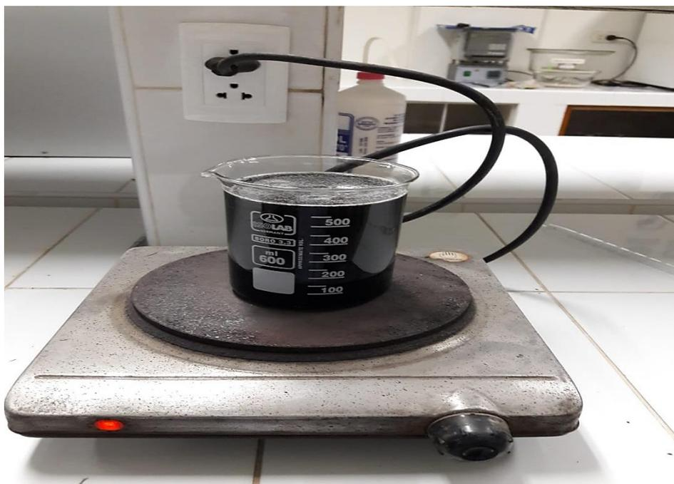
Figura 24. Ligera ebullición de muestra para posterior filtración
