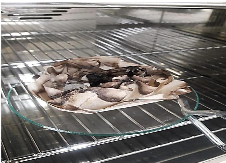
Figura 26. Colocación en estufa de papel filtro con muestra para determinación de lignina.
