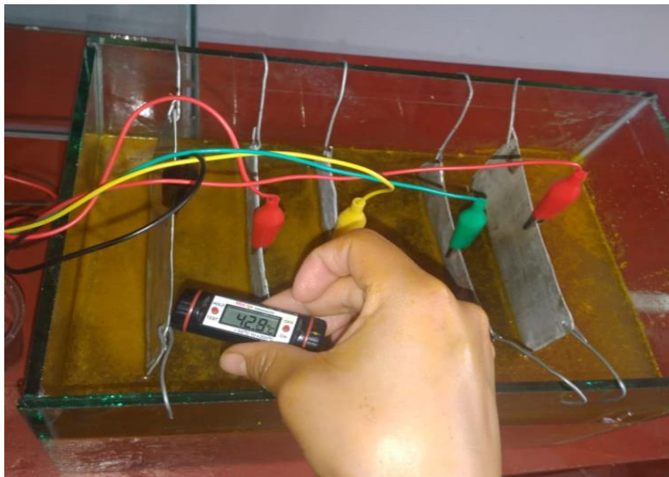
Figura 21. Medición de la temperatura durante la operación de la celda de electrocoagulación.
