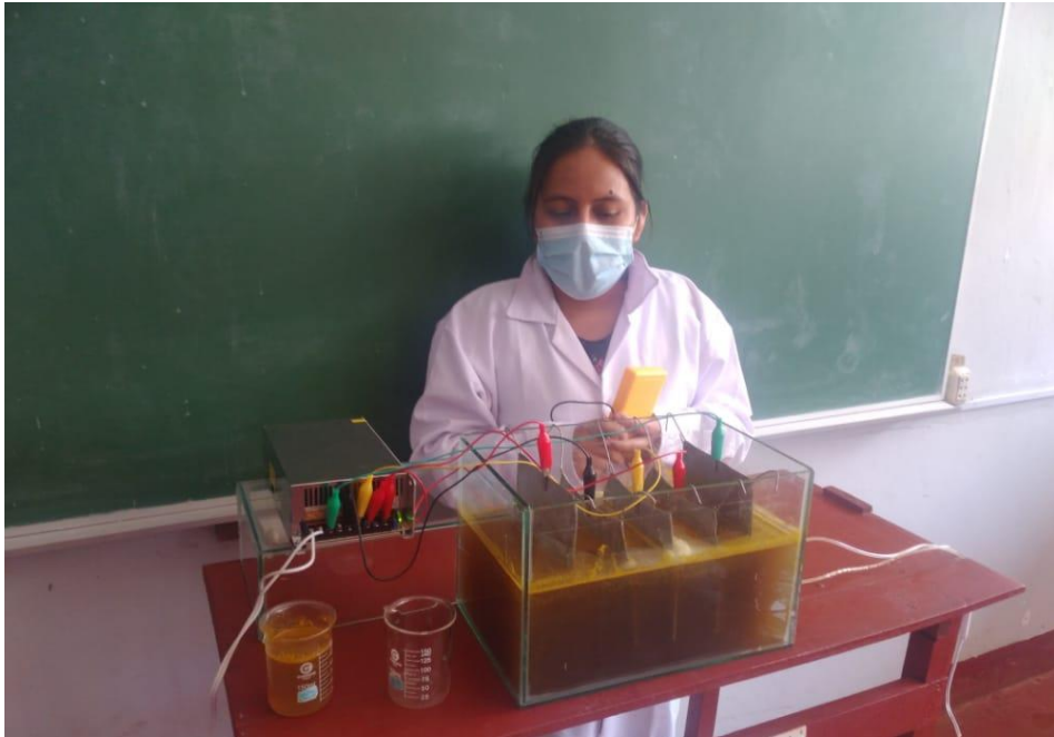
Figura 26. Verificación del voltaje y continuidad en los electrodos.
