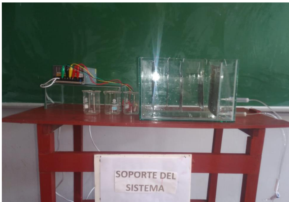
Figura 7. Prototipo de la celda de electrocoagulación de la investigación.
