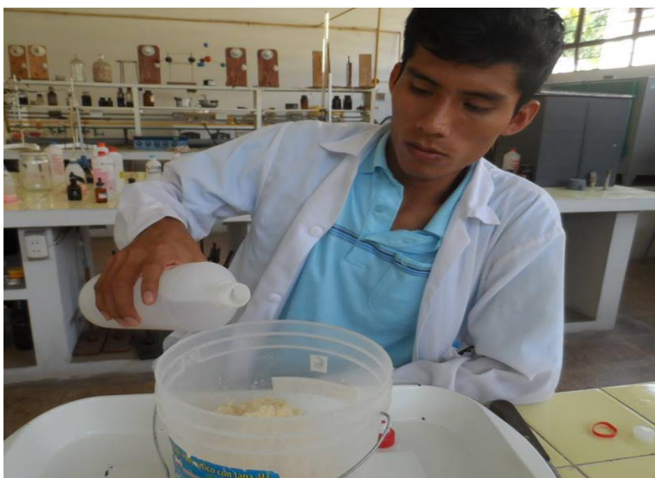
Figura 14. Adición de Etanol de 63° para eliminación de impurezas.
