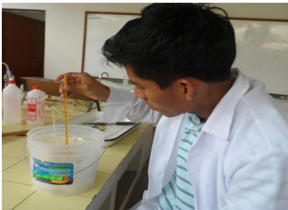
Figura 16. Lavado del albedo con NaOH 0,2M a 4 °C.
