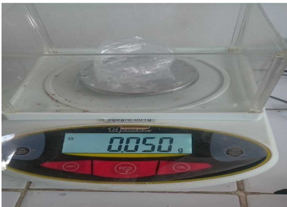
Figura 21. Pesado del biosorbente para ser usado en el proceso.
