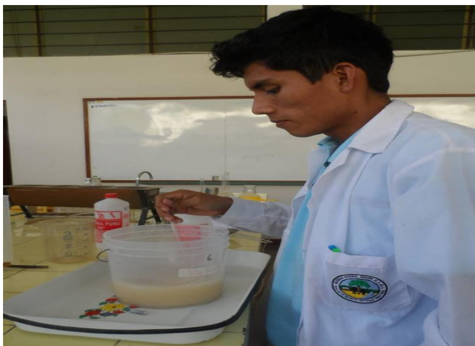
Figura 15. Lavado del albedo con alcohol de 96°.
