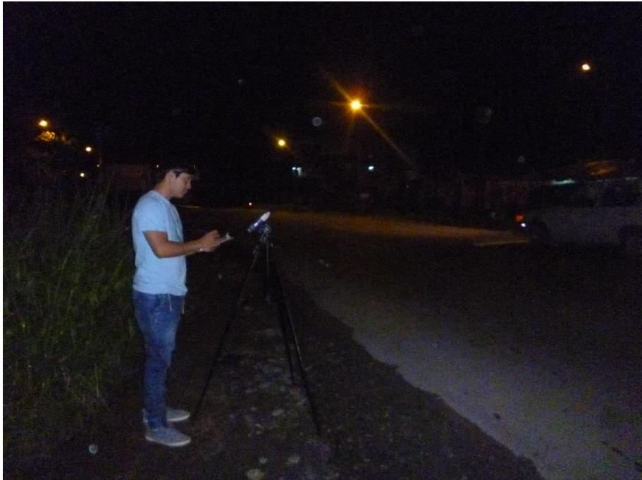
Figura 19. Medición del LAeqT en el punto A1 de la zona de Afilador en el turno nocturno.
