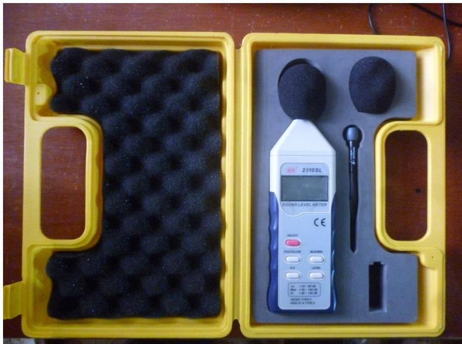
Figura 24. Sonómetro marca SEW, Modelo 2310, Tipo II, serie 1281255; utilizado en las mediciones.
