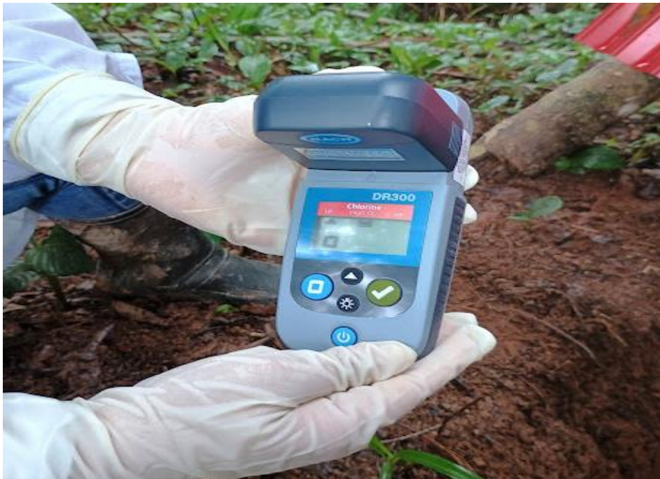
Figura 22. medición de cloro residual en el reservorio 7 de Junio
