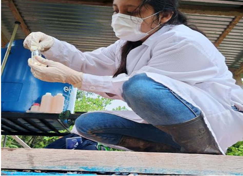
Figura 25. Adición del reactivo para analizar cloro residual
