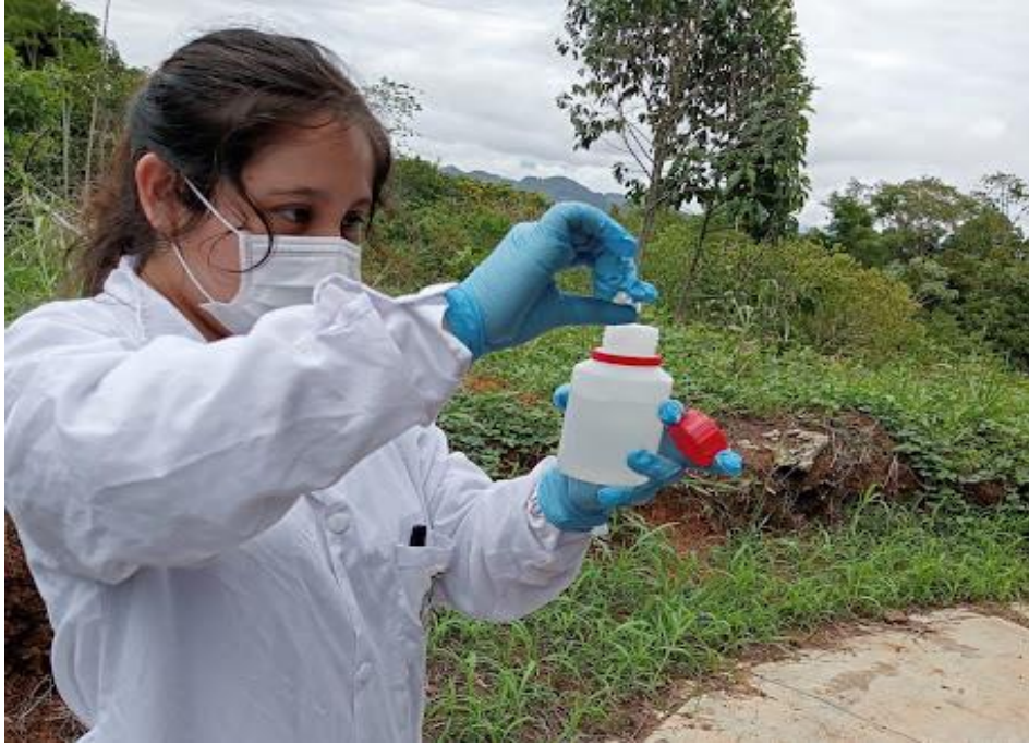
Figura 19. Adición del preservante Tiosulfato de Sodio
