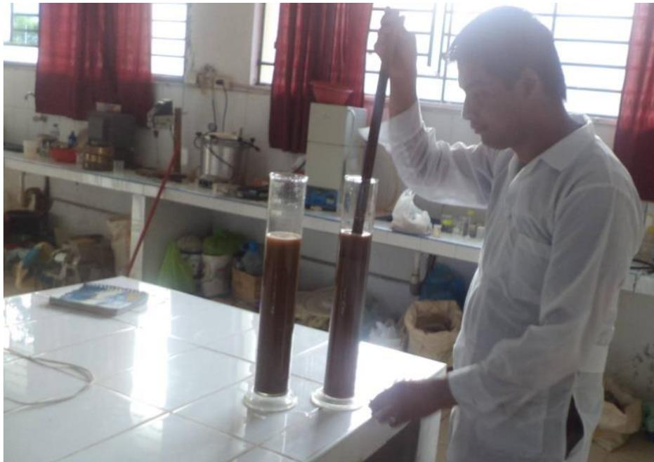
Figura 12. Agitamiento de partículas suspendidas para análisis del suelo.
