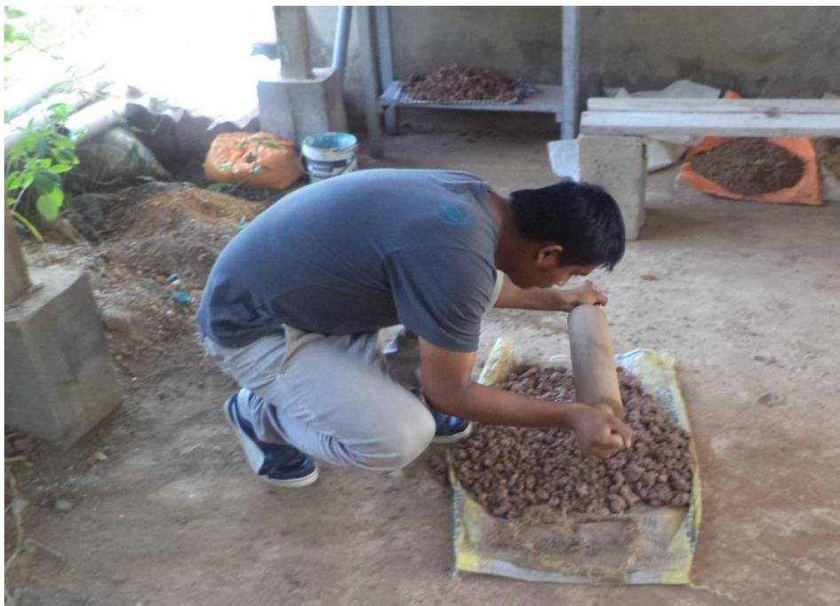
Figura 10. Trituración de la muestra de suelo seco.
