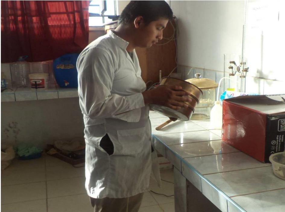
Figura 11. Tamizaje de la muestra de suelo según la granulometría.
