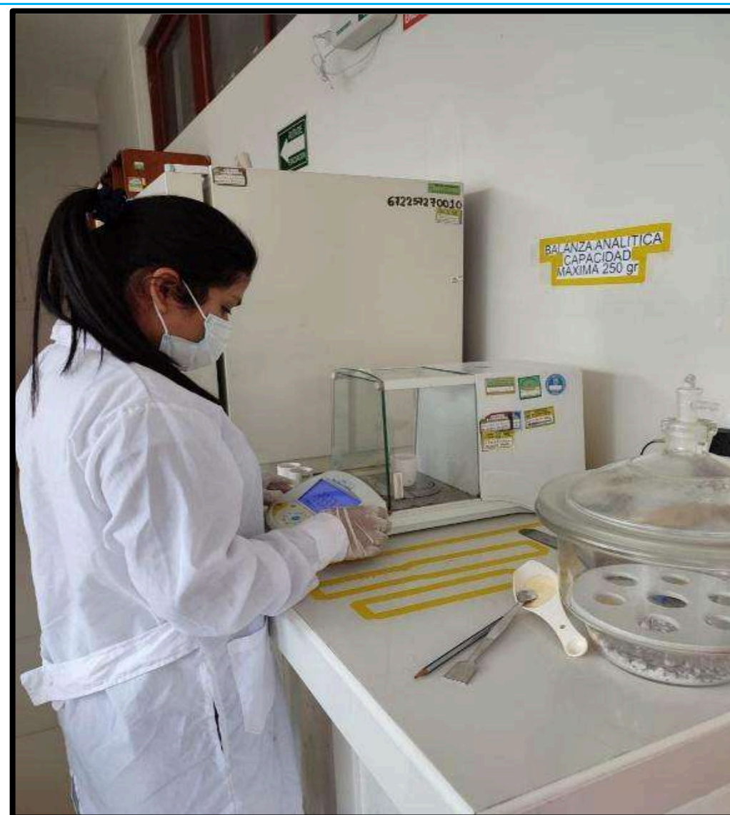
Evaluación de la humedad
