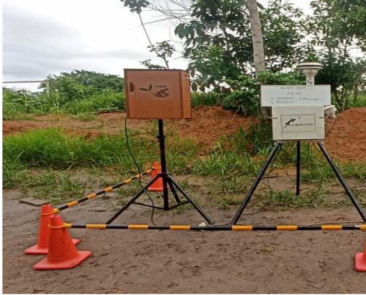
Figura 22. Instalación completa de los equipos de muestreo del PM 10 y CO en el DME 2
