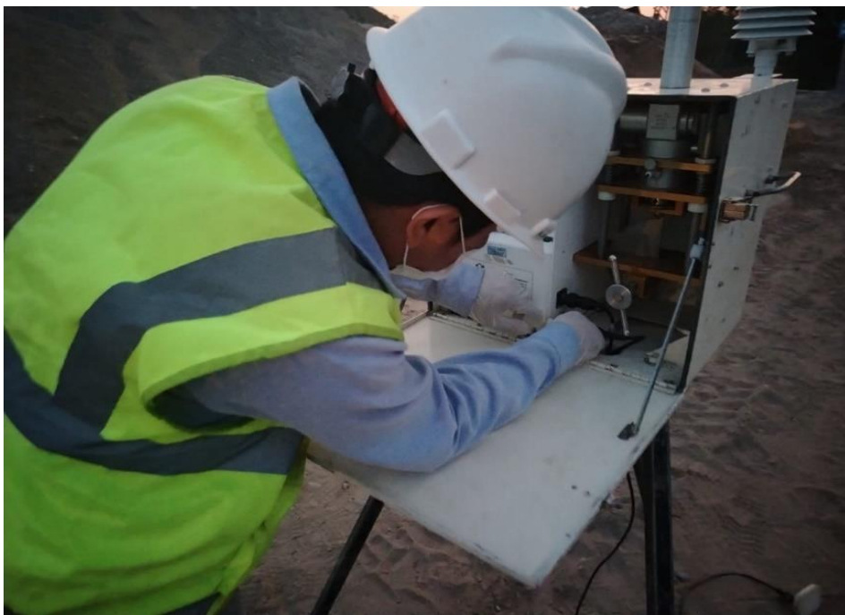
Figura 15. Colocación del filtro PM_{10} en el equipo Tecora para la medición del PM_{10} en la planta de concreto
