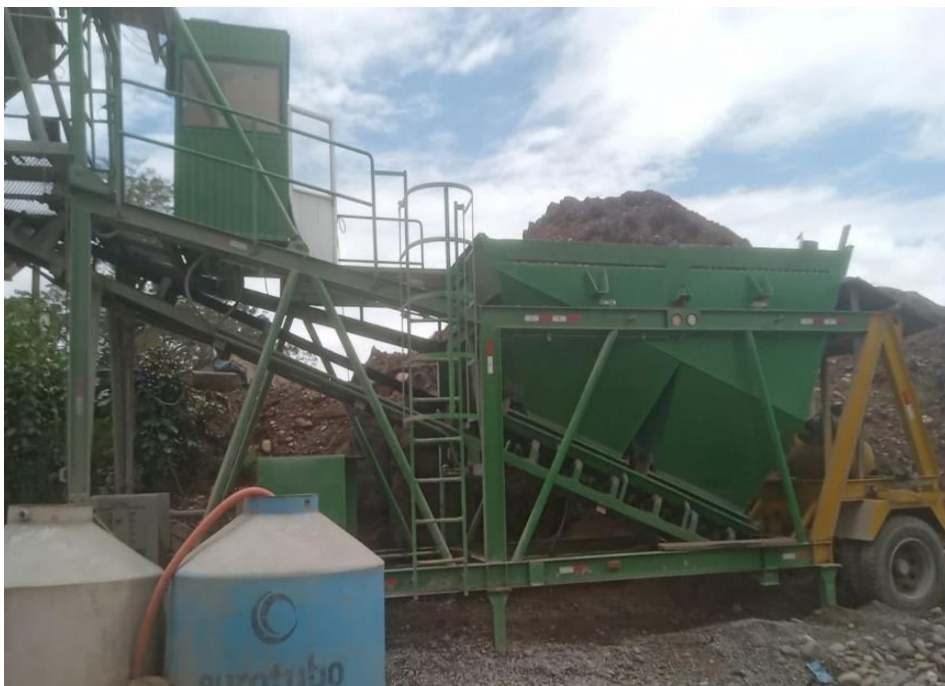
Figura 11. Tolvas de grava y arena
