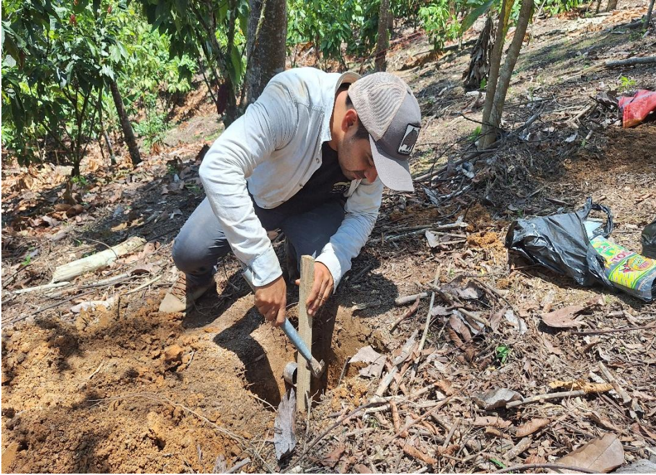
Figura 25. Recolección de suelo con cilindro muestreador para densidad aparente
