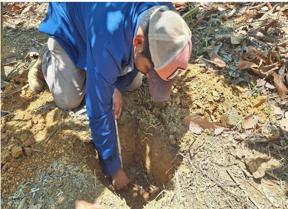
Figura 26. Medición de la profundidad del suelo
