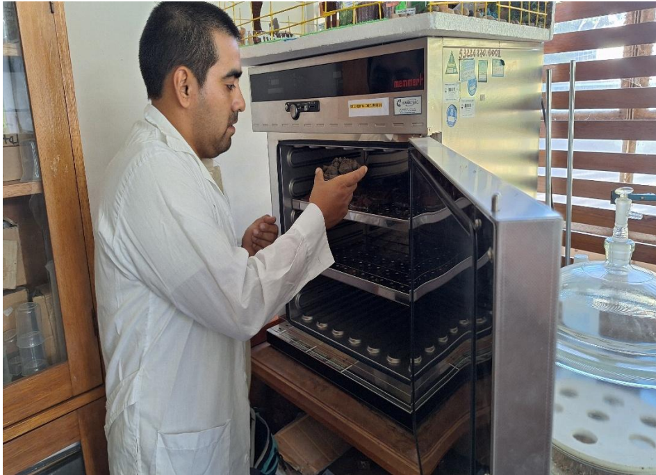
Figura 27. Secado de muestras de suelo en estufa
