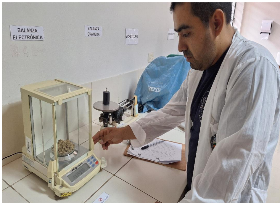
Figura 30. Determinación del peso seco de las muestras de suelo
