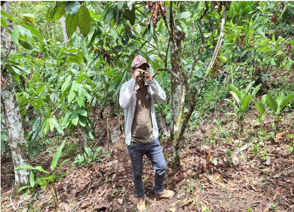
Figura 18. Medición de altura del árbol con telémetro digital Forestry Pro II.
