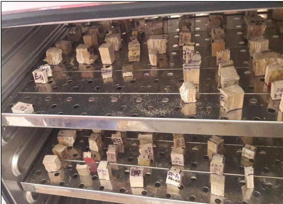
Figura 18. Secado de probetas (3 cm x 3 cm) en estufa para determinar el contenido de humedad.
