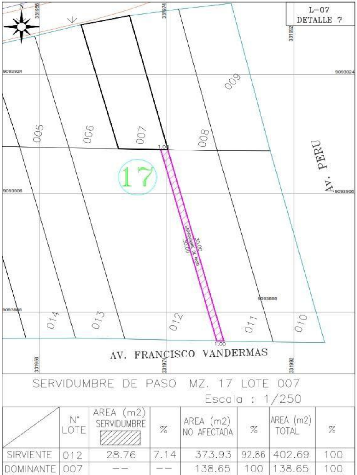
Figura 17. Plano detalle 7 de servidumbre de paso.
