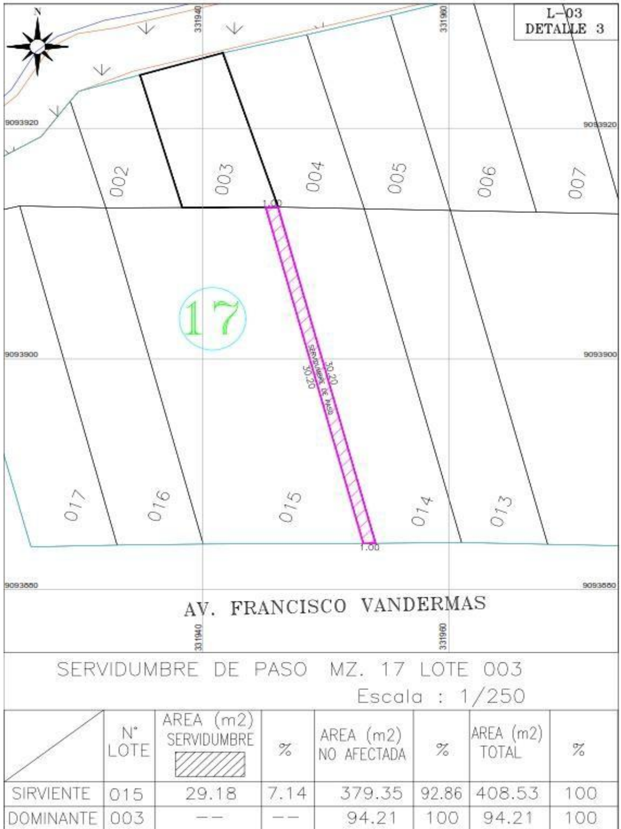
Figura 13. Plano detalle 3 de servidumbre de paso.
