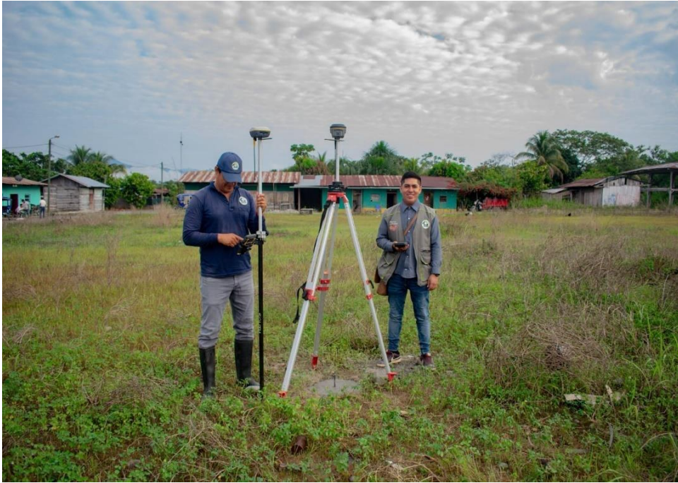
Figura 25. GPS diferencial instalada, listo para la toma de puntos
