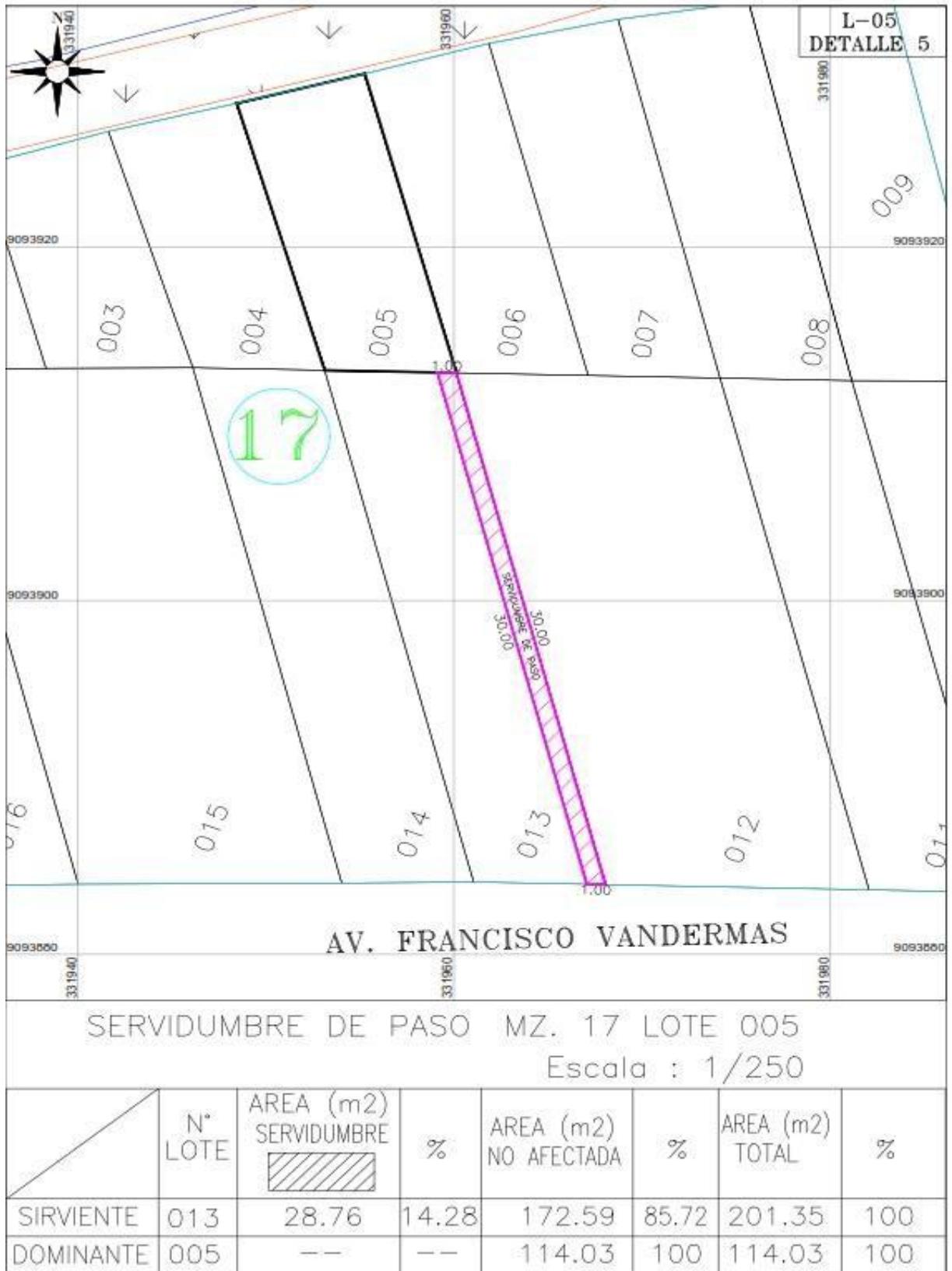
Figura 15. Plano detalle 5 de servidumbre de paso.
