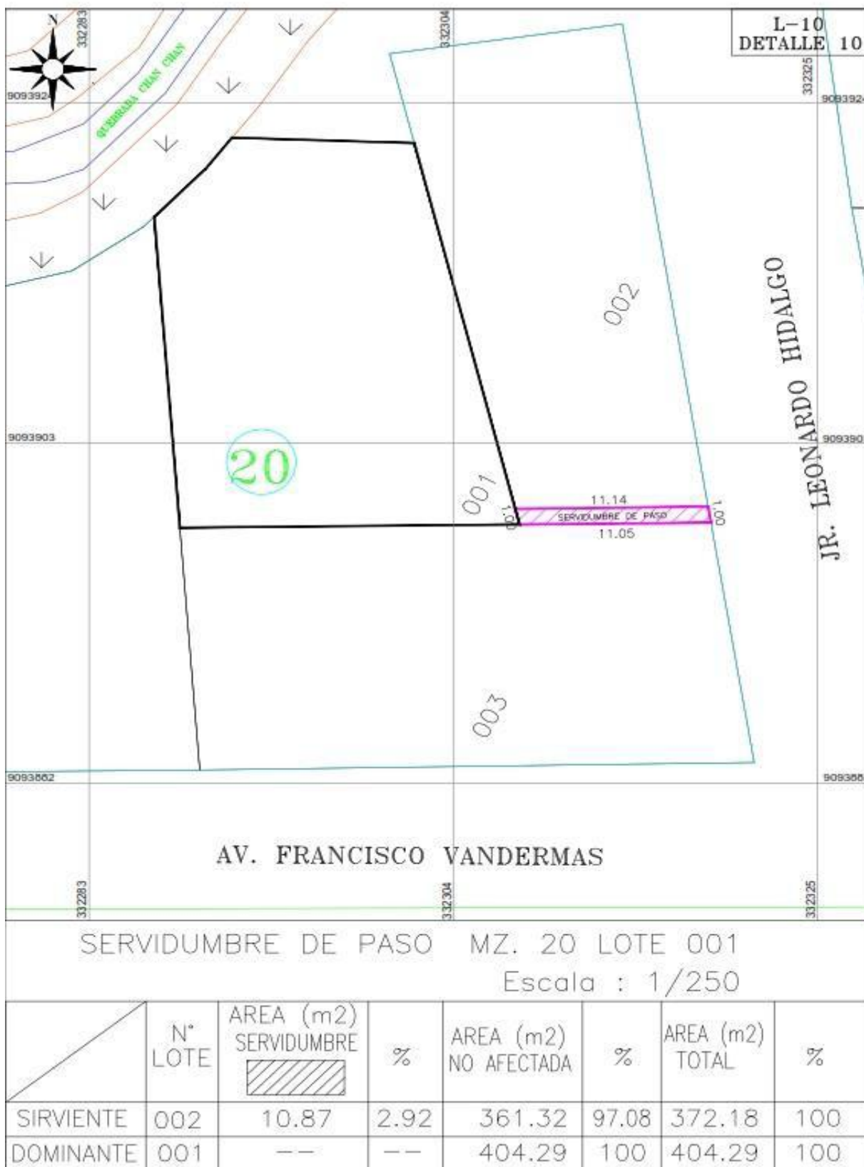
Figura 20. Plano detalle 10 de servidumbre de paso.
