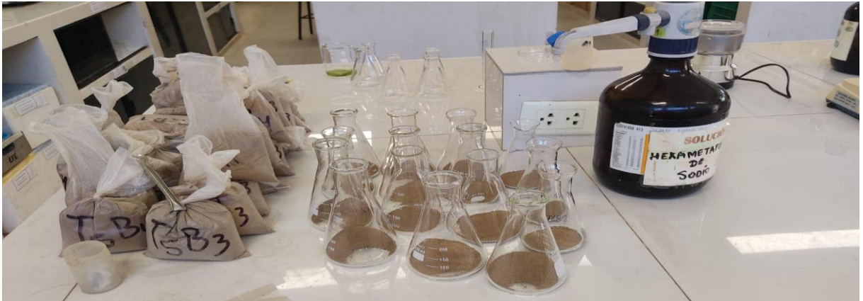
Figura 57. Pesado de muestras de suelo por unidad experimental para el fraccionamiento químico
