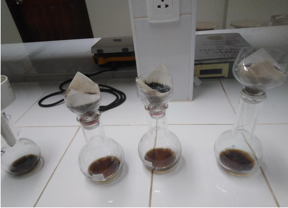
Figura 11. lavado de carbón activado con ácido clorhídrico diluido
