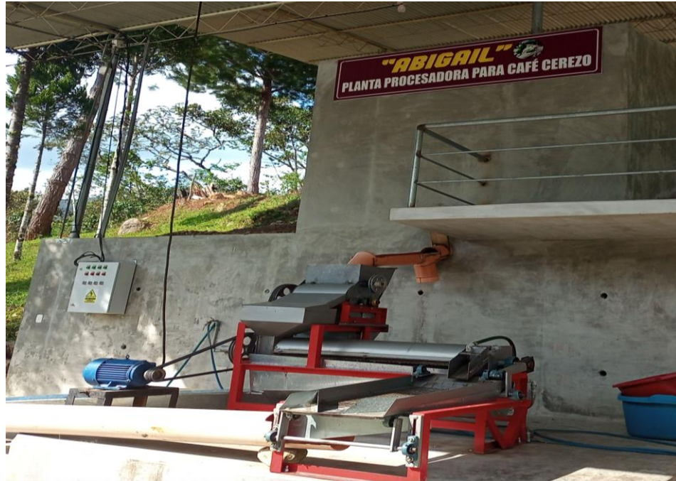
Figura 14. Planta procesadora para café cerezo “Abigail” para el proceso de despulpado y lavado del café cerezo.
