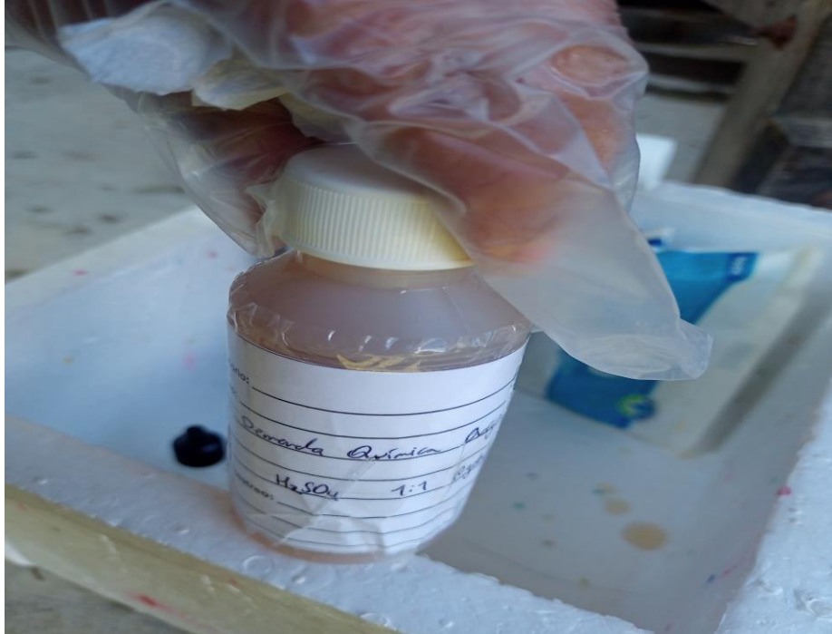
Figura 16. Envasado de la muestra del agua residual del proceso de despulpado del café.
