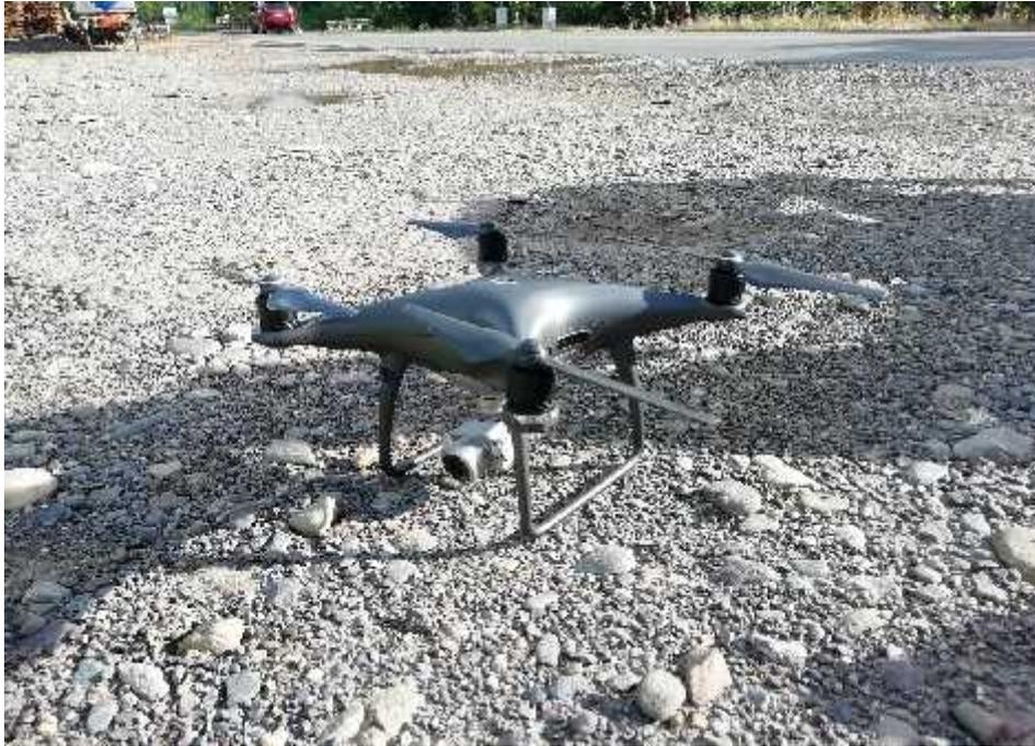
Figura 18. Drone PHANTON 4 Pro utilizado para el levantamiento fotográfico.
