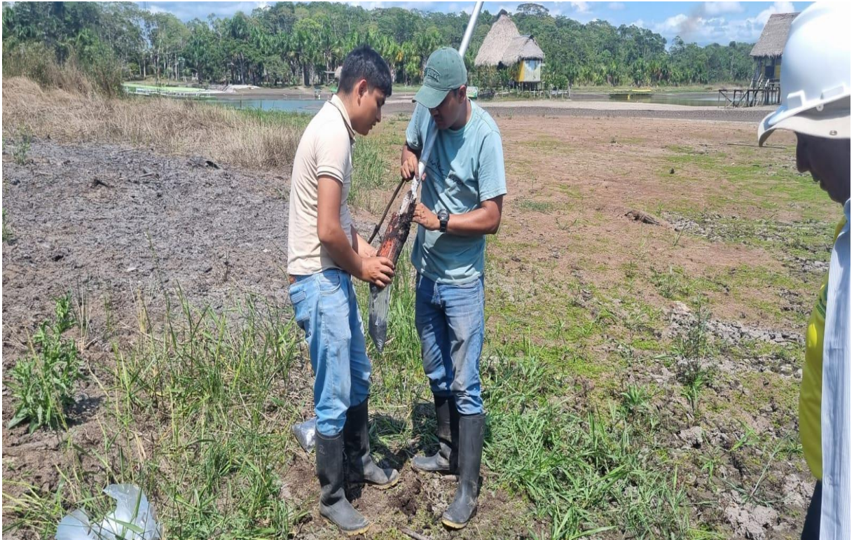
Figura 29. Recolección de muestras de suelos en los tres niveles de profundidad de la unidad muestral B de la zona litoral.
