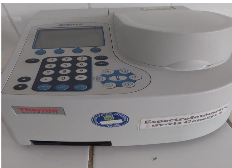
Equipo espectrofotómetro modelo GENESYS-6 THERMO SCIENTIFIC (UV-Vis).
