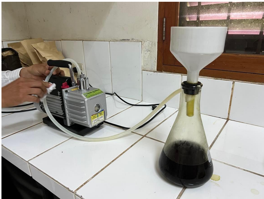
Figura 18. Filtrado del extracto con ayuda de una bomba al vacío, papel filtro y un embudo buchner.
