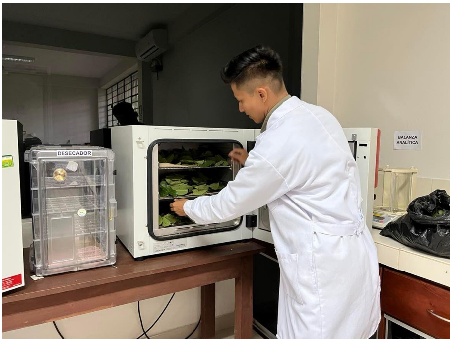
Figura 14. Secado de las hojas de guayaba seleccionadas en una estufa aire forzado a una temperatura de 55 °C por 72 horas.
