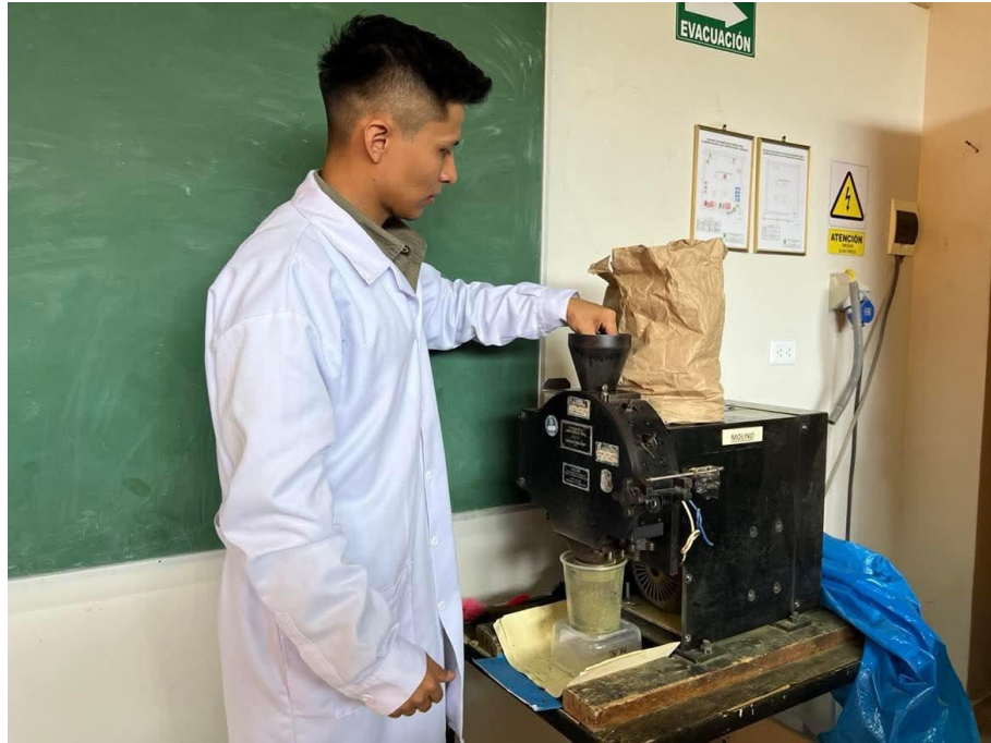
Figura 15. Proceso de triturado de las hojas secas en un molino de cuchillas marca con zaranda de 1 mm de diámetro.
