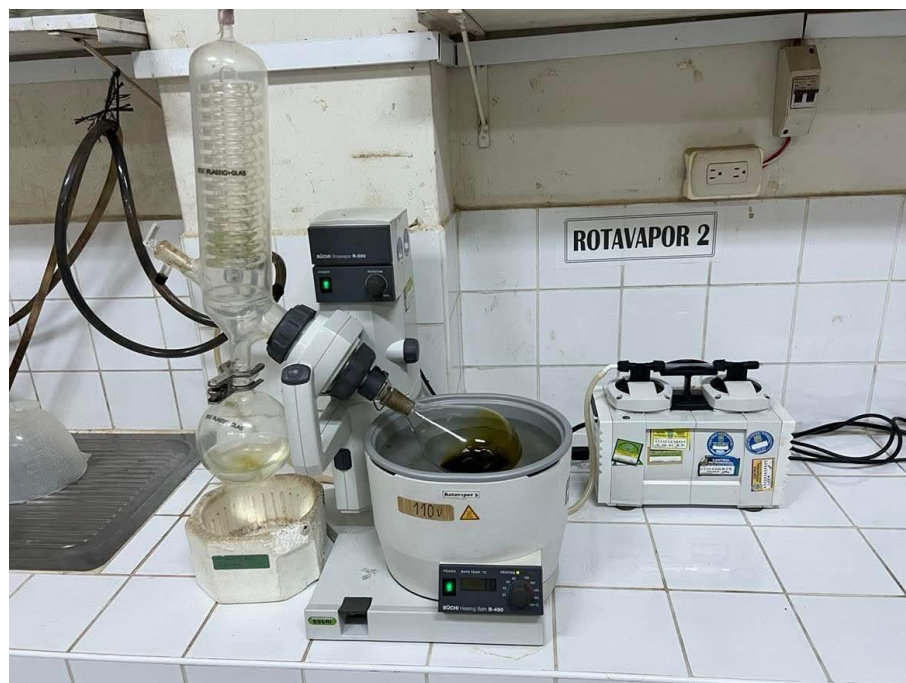
Figura 19. Evaporación a presión con la ayuda de un evaporador de vacío rotatorio (BUCHI India Pvt.117 Ltd, Mumbai, India).
