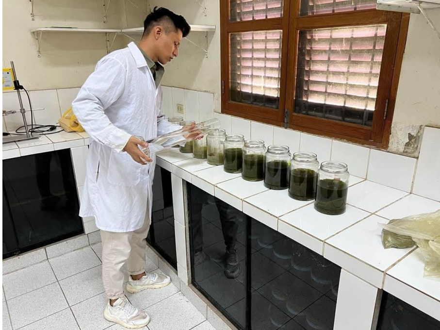
Figura 17. Vertiendo alcohol etanólico al 75% a las muestras de harina de hojas de guajava.
