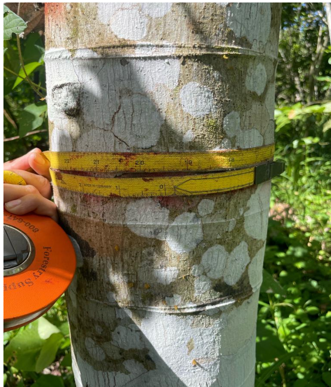
Figura 27. Medición del diámetro con la cinta diamétrica.
