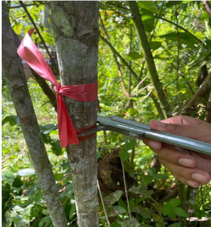
Figura 28. Medición del diámetro con vernier.
