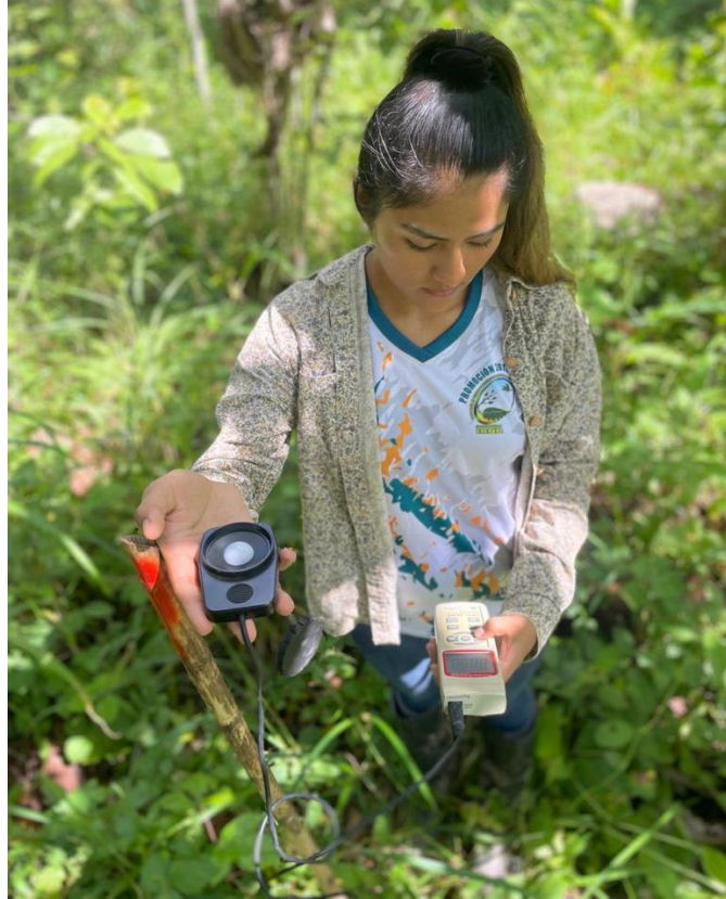
Figura 26. Medición de la iluminación con el Luxómetro en las unidades muestrales.
