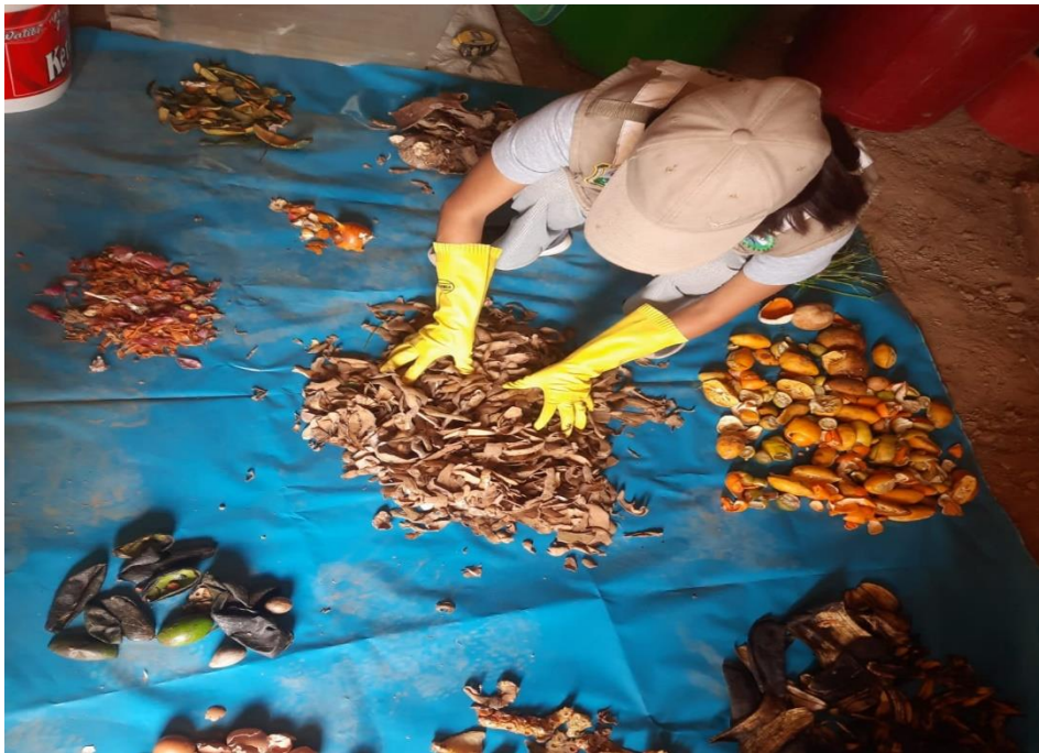
Figura 30. Separación de los residuos recolectados para determinar su composición
