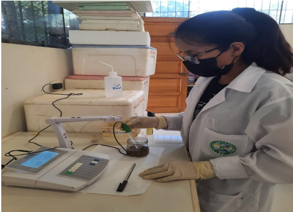
Figura 33. Medición de pH con el multiparámetro en el laboratorio de la UNAS
