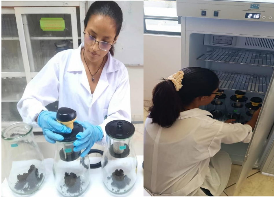
Figura 41. Medición de la reactividad del compost obtenido de los tratamientos
