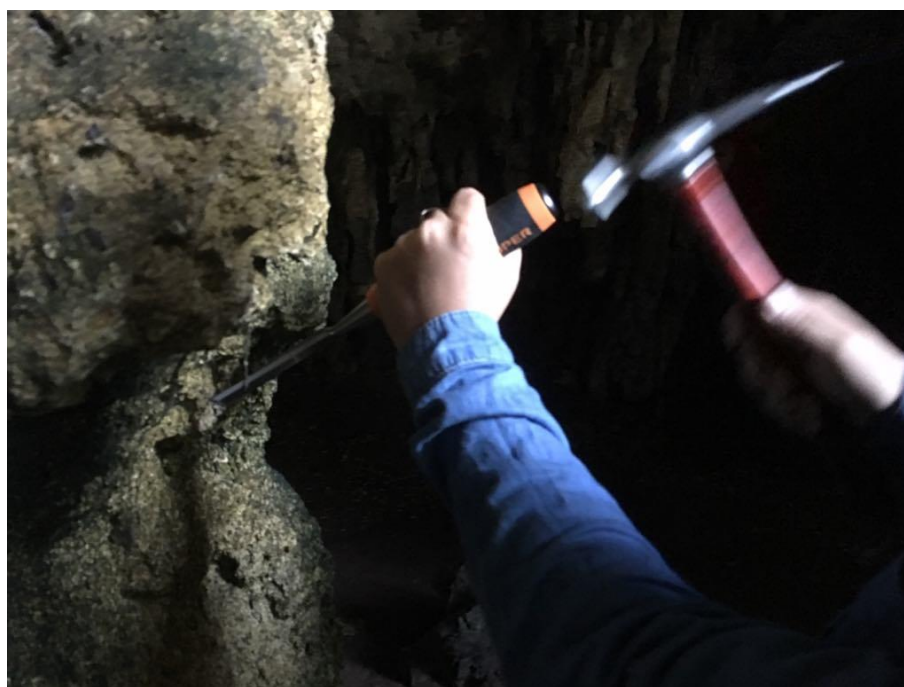
Figura 15. Inserción del formón en estalagmita en la zona de la entada de la Cueva de las Lechuzas.
