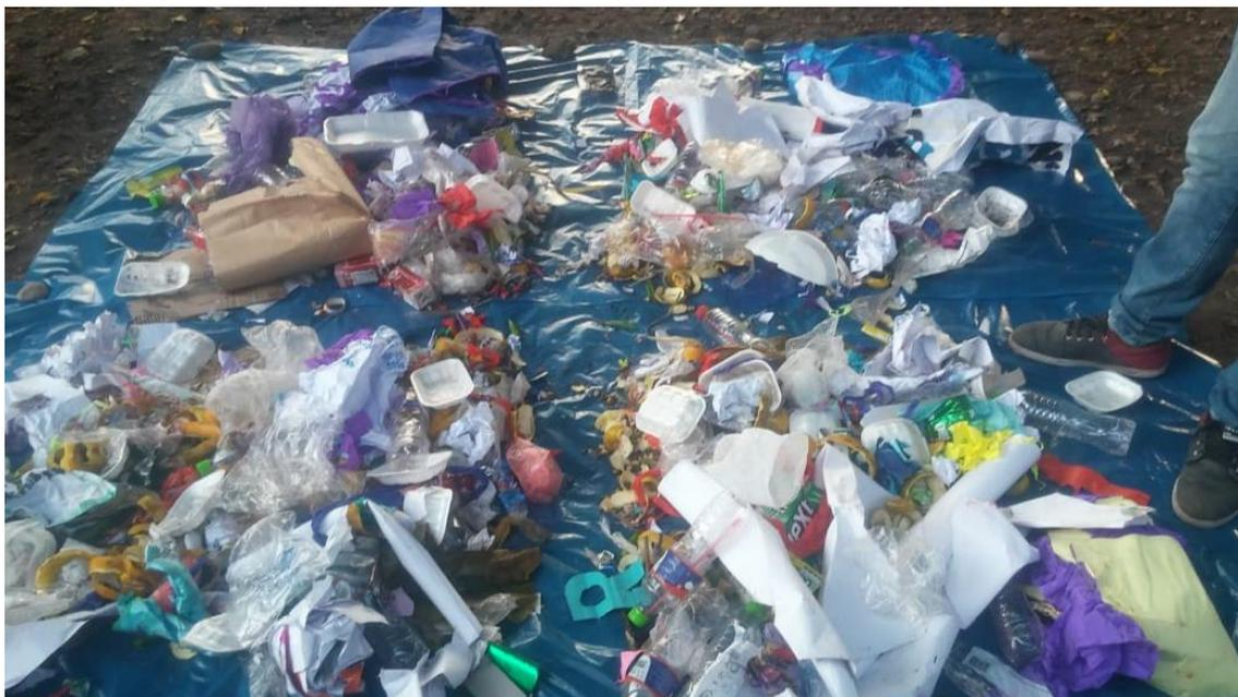
Figura 25. Método del cuarteo para la caracterización de residuos sólidos.
