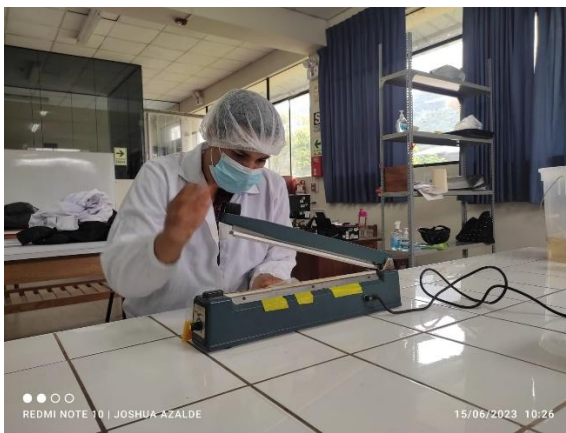
Sellado de bolsas con pulpa azucarada
