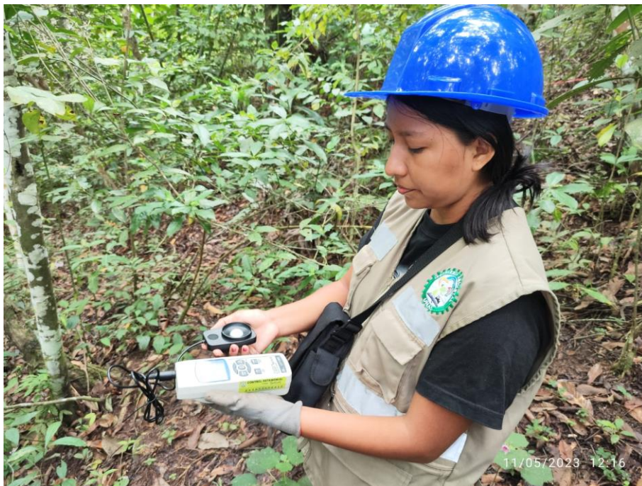
Figura 39. Toma de datos con el luxómetro en el turno del mediodía
