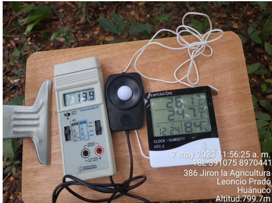
Figura 42. Toma de datos de microclima con el luxómetro y el termohigrómetro
