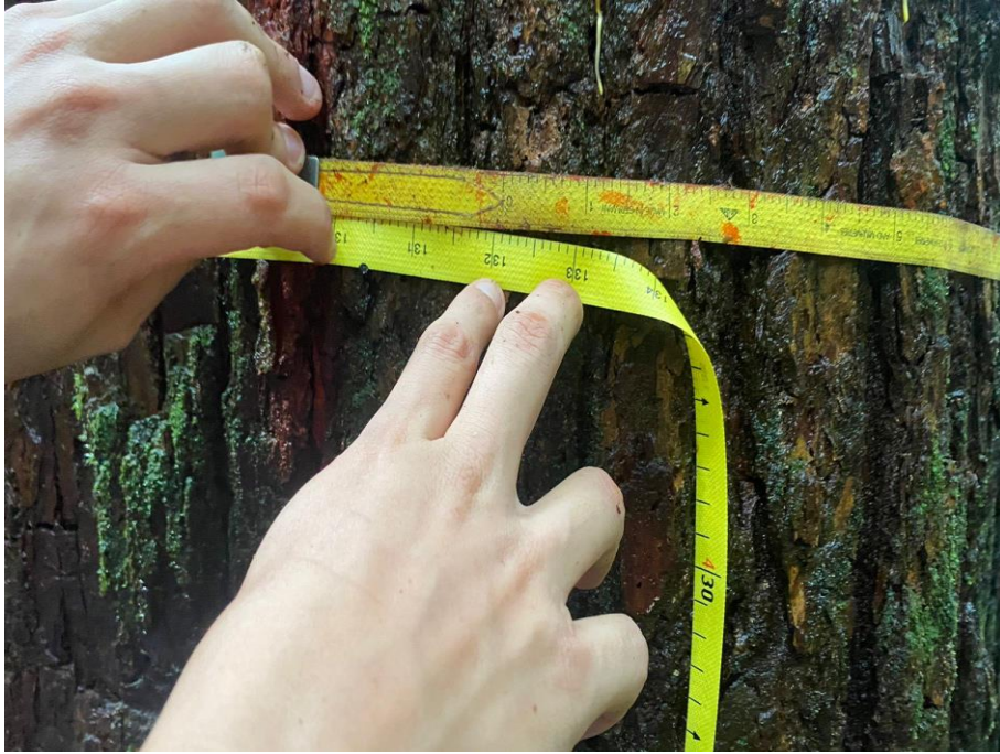
Figura 23. Lectura del diámetro de los árboles en la cinta diamétrica
