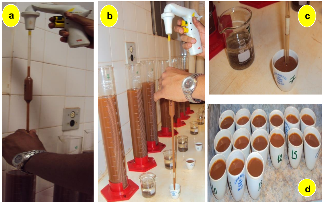
Figura 20. a. Extracción de la fracción de arcilla, b y c. Transferencia de la fracción de arcilla, d. secado de la fracción de arcilla
