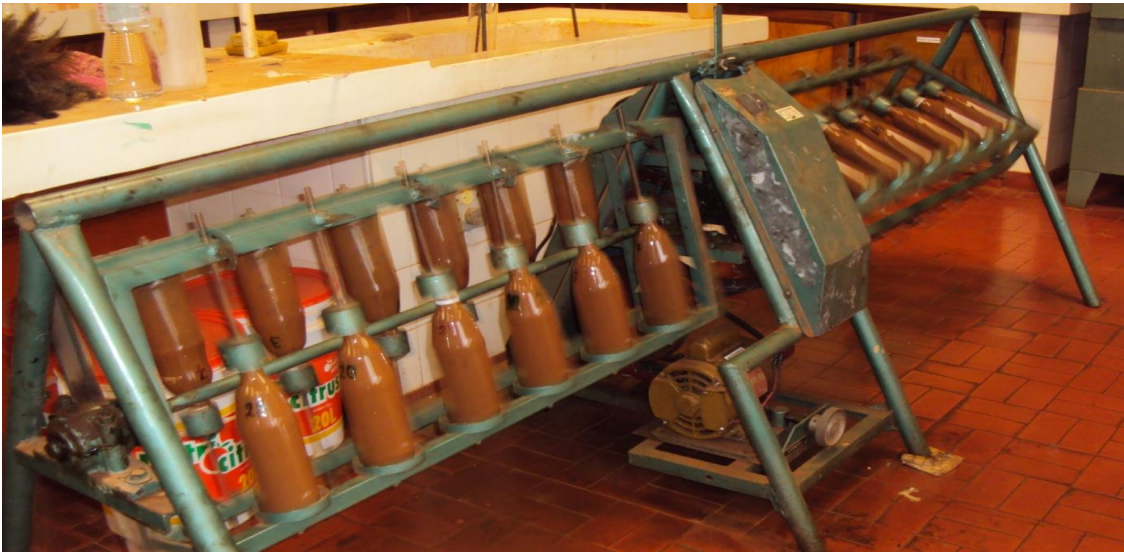
Figura 15. Agitador rotatorio de Wiegner, para análisis textural.
