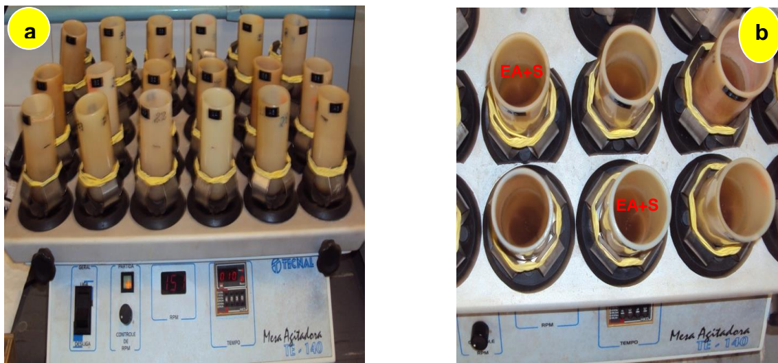
Figura 21. a. y b. Proceso de agitación del extracto alcalino (EA) y el suelo (S).
