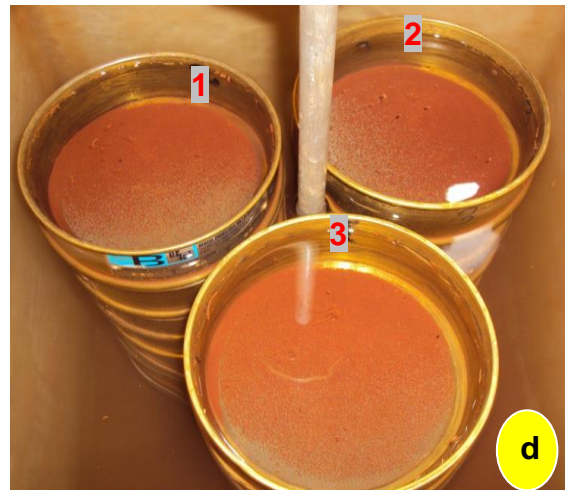
Figura 33. a. Codificación de las muestras en relación a los tamices, b y c. Posicionamiento y transferencia de los agregados, d. Oscilación de los agregados.
