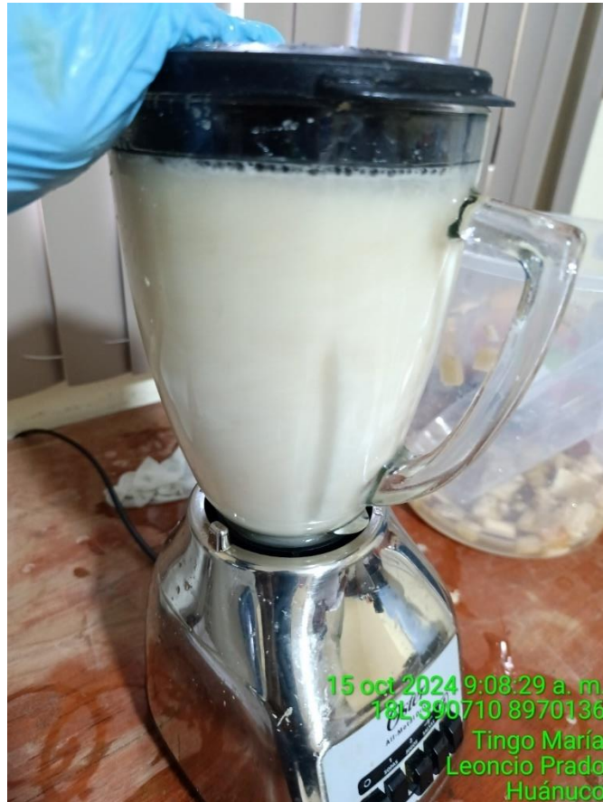
Figura 7. Triturado de la muestra de pseudotallo de plátano con solución de HCL.
