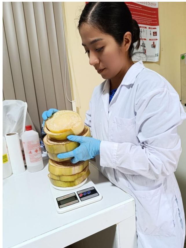
Figura 4. Registro del peso de la muestra de pseudotallo de plátano en rodajas.
