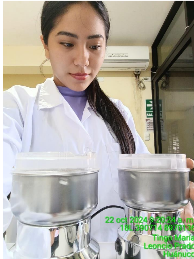
Figura 11. Molienda de la muestra seca del pseudotallo de plátano.
