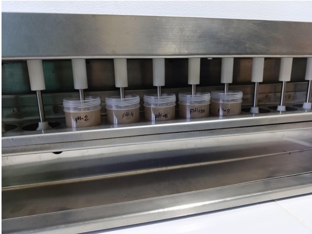
Figura 17. Agitación de los tratamientos con diferentes dosis de adsorbente.
