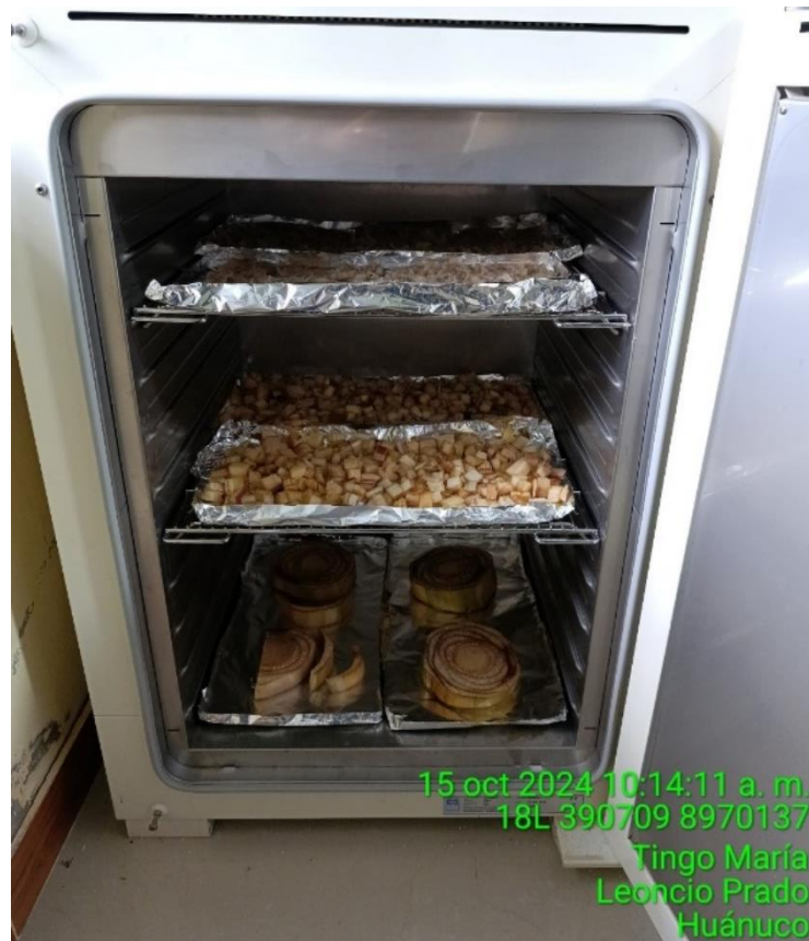
Figura 9. Secado de la muestra de pseudotallo de plátano en la estufa 50° por 36 horas.
