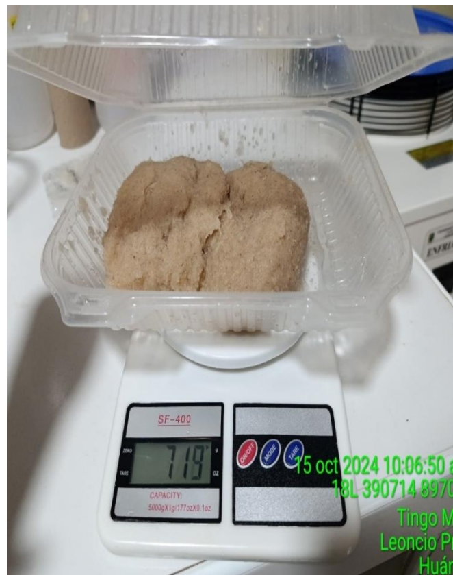
Figura 8. Peso de la muestra del pseudotallo de plátano obtenida después de triturado.
