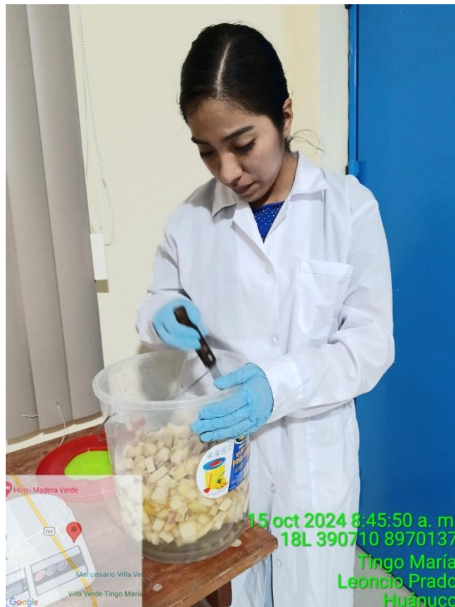
Figura 6. Inmersión de la muestra de pseudotallo de plátano en HCl 10% por 40 min.
