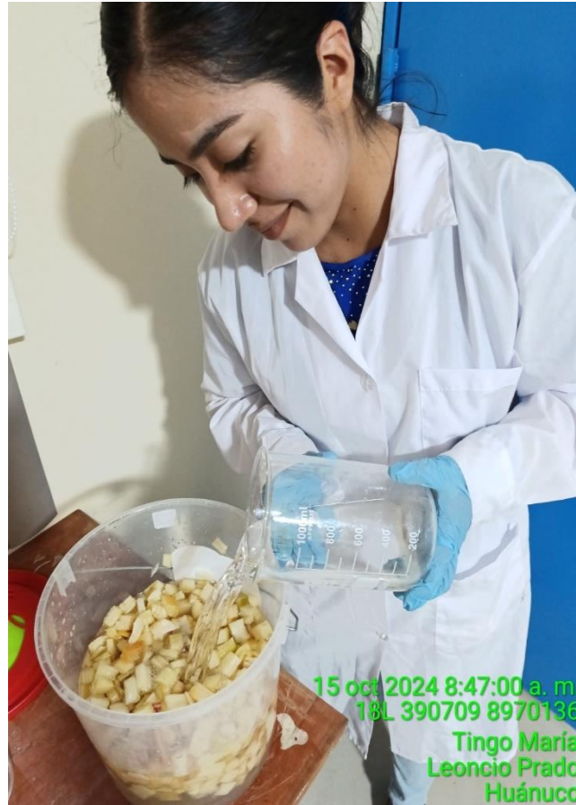
Figura 5. Lavado de la muestra de pseudotallo de plátano cortado en pequeñas fracciones.
