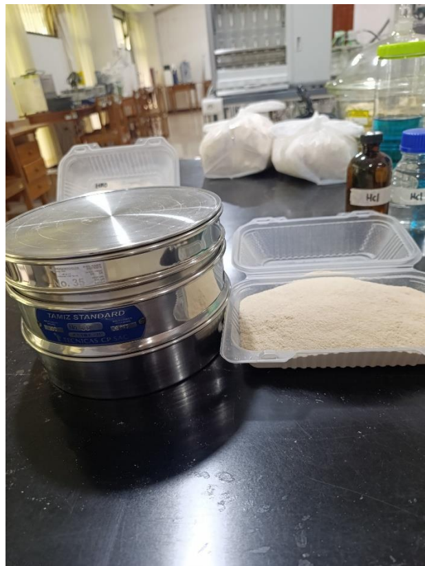
Figura 12. Tamizado de la muestra seca del pseudotallo de plátano.
