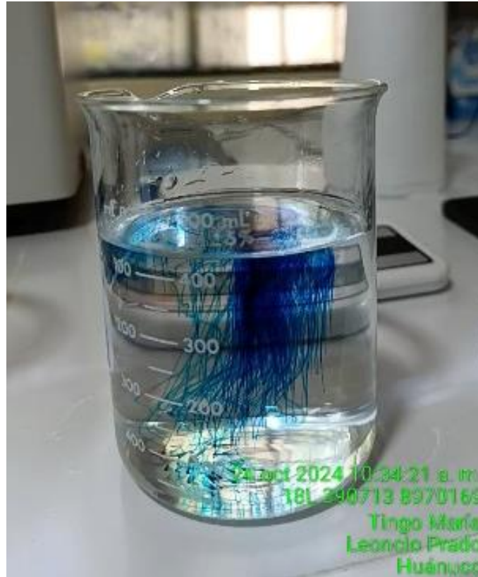
Figura 13. Preparación de las concentraciones de azul de metileno en agua destilada.
