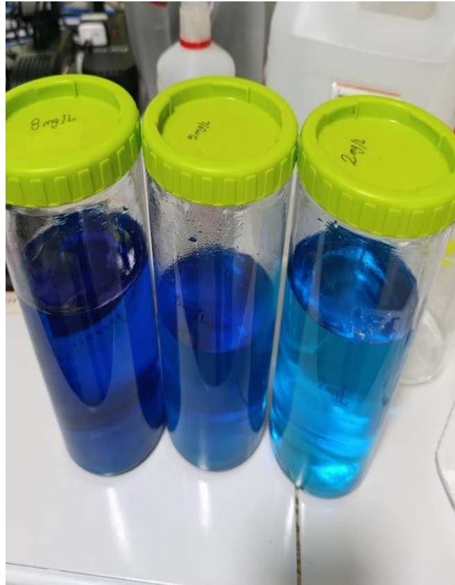
Figura 15. Concentraciones de azul de metileno en agua destilada de 2mg/L, 5mg/L y 8mg/L.
