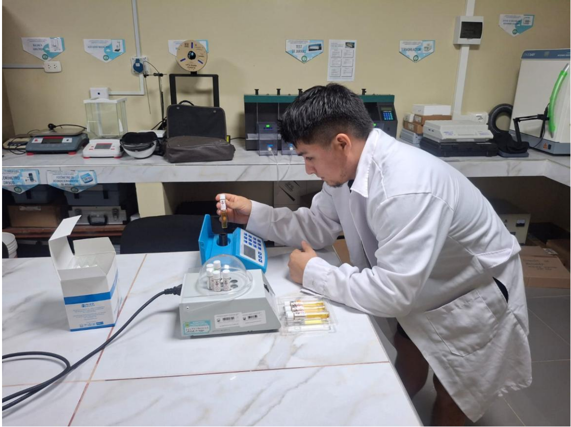
Figura.34. Medición de la DQO a las muestras digeridas.
