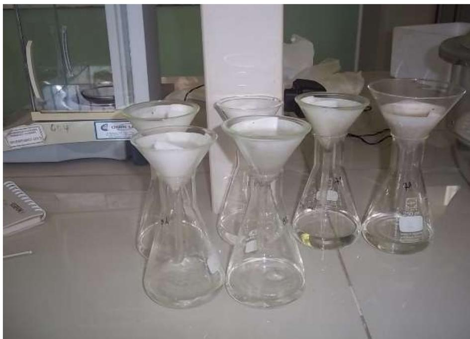
Figura 36. Filtración del agua que contiene material particulado sedimentable.
