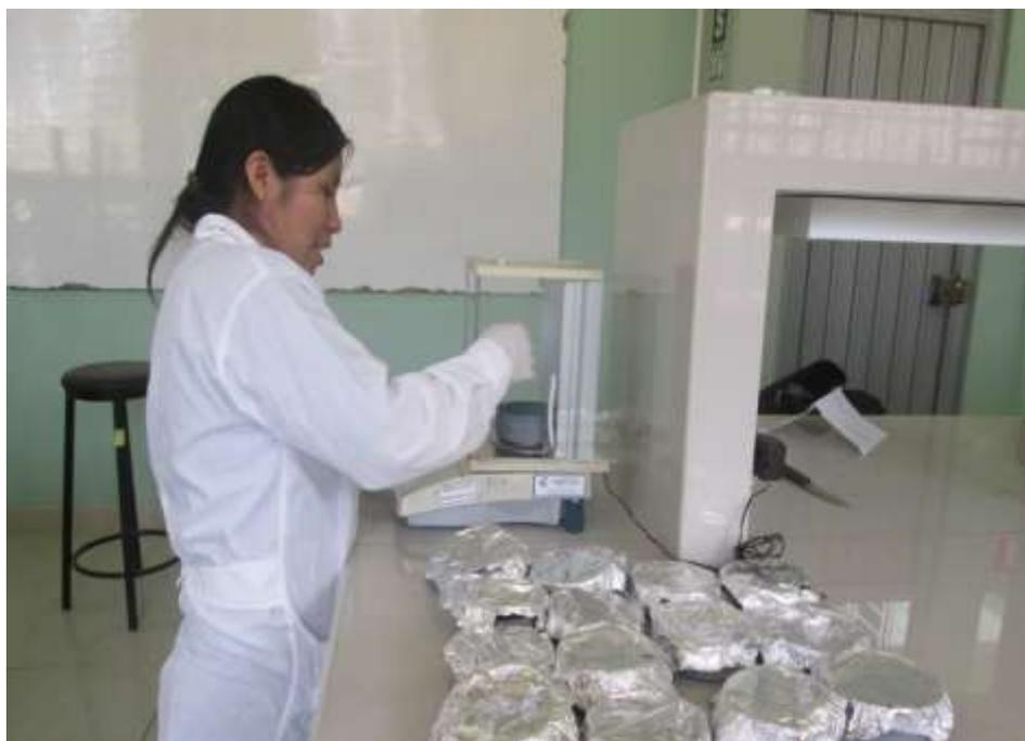
Figura 35. Pesado de las muestras colectadas por el método de tubos pasivos.
