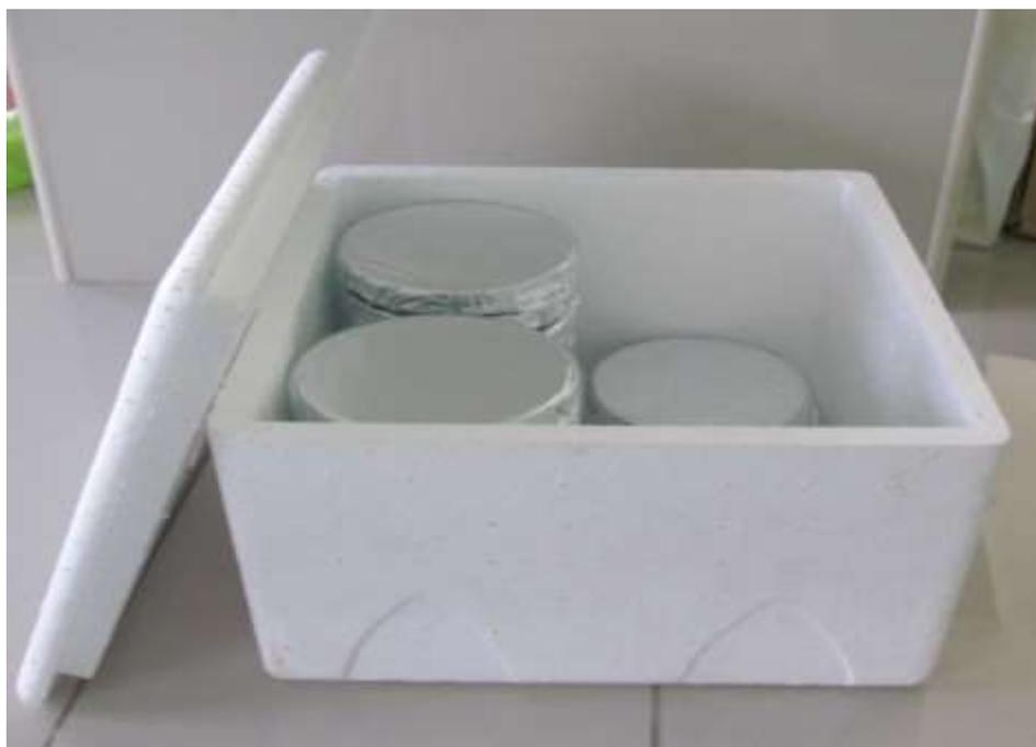
Figura 28. Caja conservadora (tecnopor) para el traslado de las muestras.
