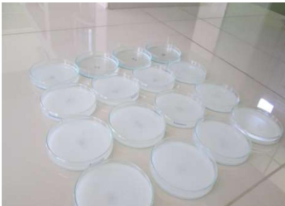
Figura 25. Muestras preparadas para el método de placas receptoras.
