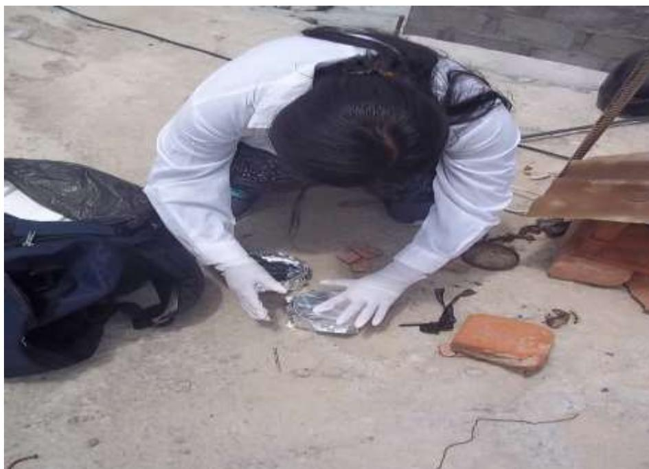
Figura 34. Recojo de muestras de las placas receptoras.
