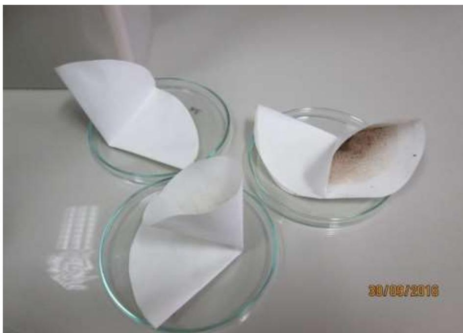
Figura 41. Papel filtro desecado que contiene material particulado sedimentable.
