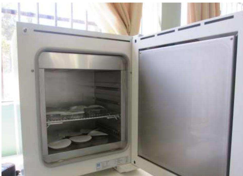
Figura 29. Secado de los filtros para obtener peso constante.
