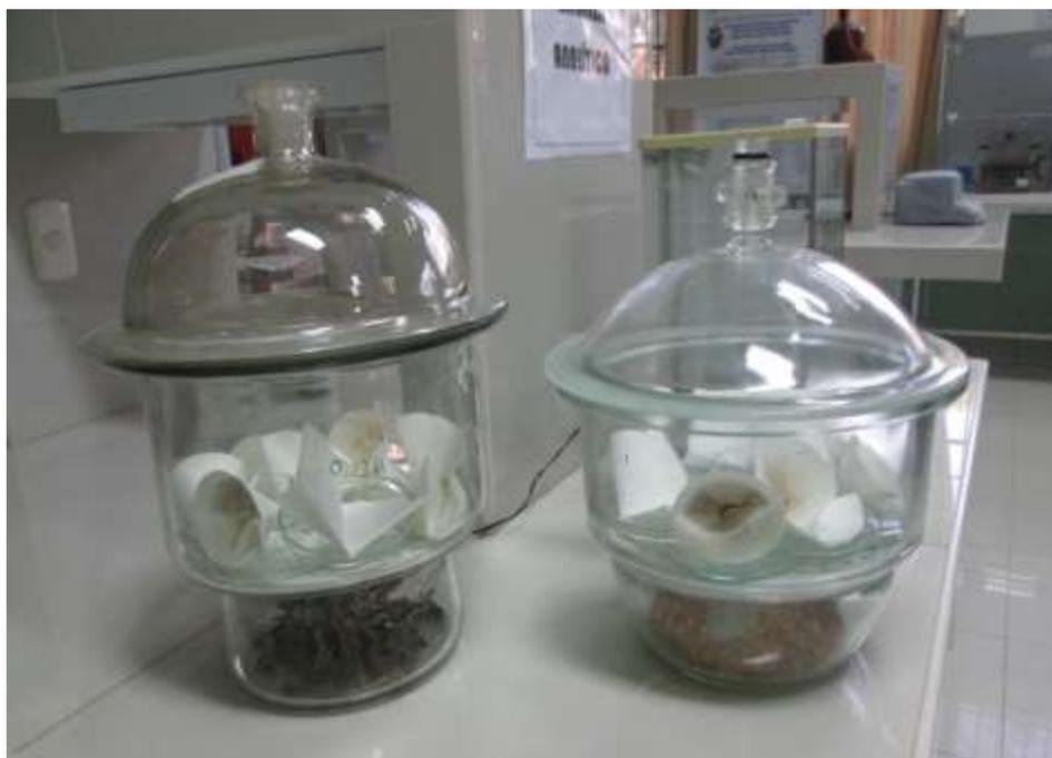
Figura 40. Deseccando los filtros que contienen material particulado sedimentable.
