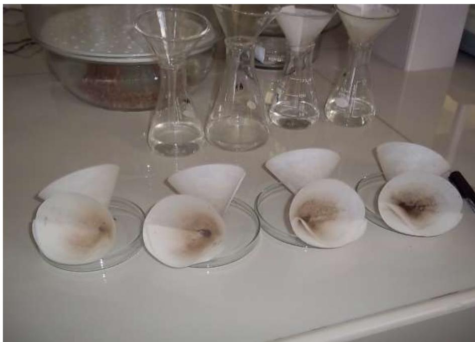
Figura 37. Filtros contenidos con material particulado sedimentable.
