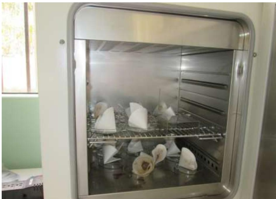
Figura 39. Secado de los filtros que contienen material particulado sedimentable.
