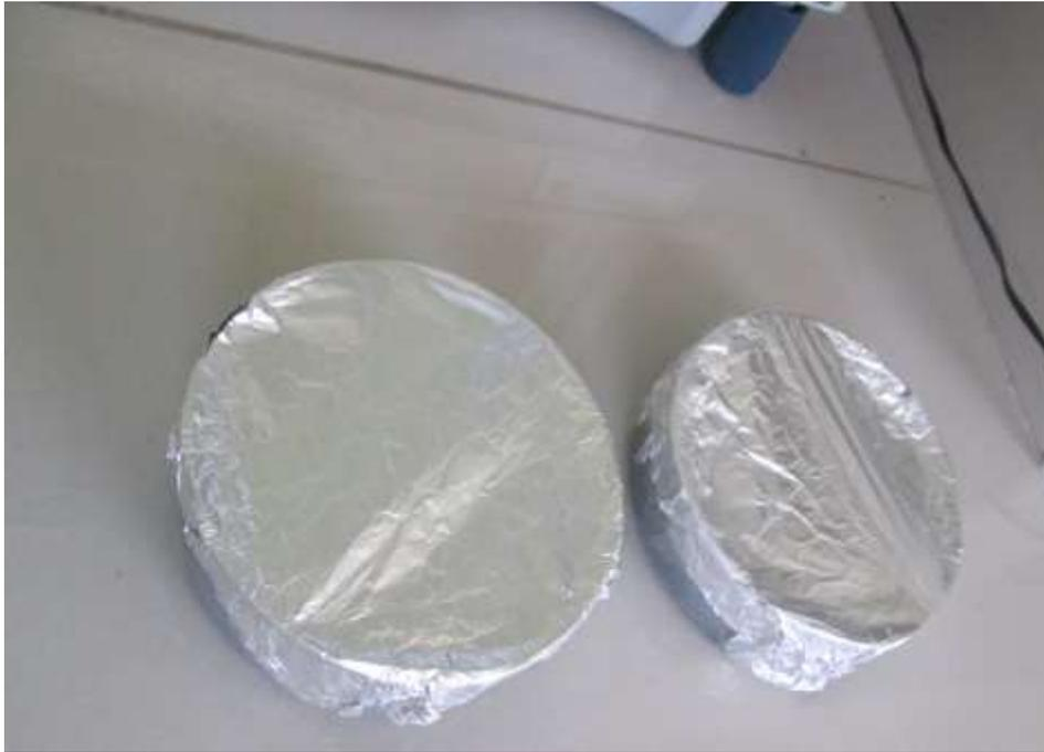
Figura 32. Cubierta de aluminio para los tapones.
