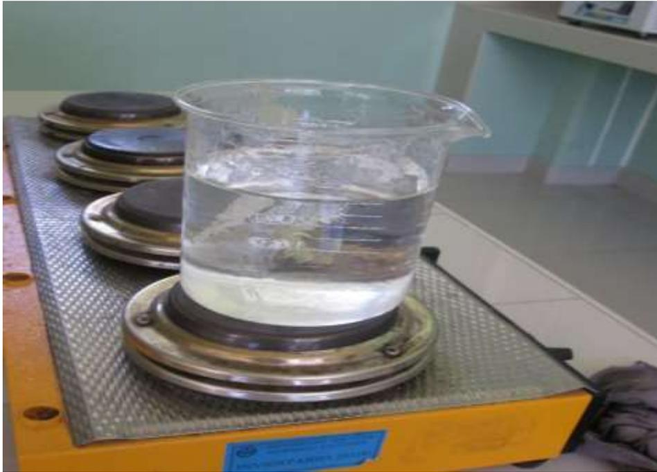
Figura 22. Fundición de la vaselina para ser vertida en las placas.
