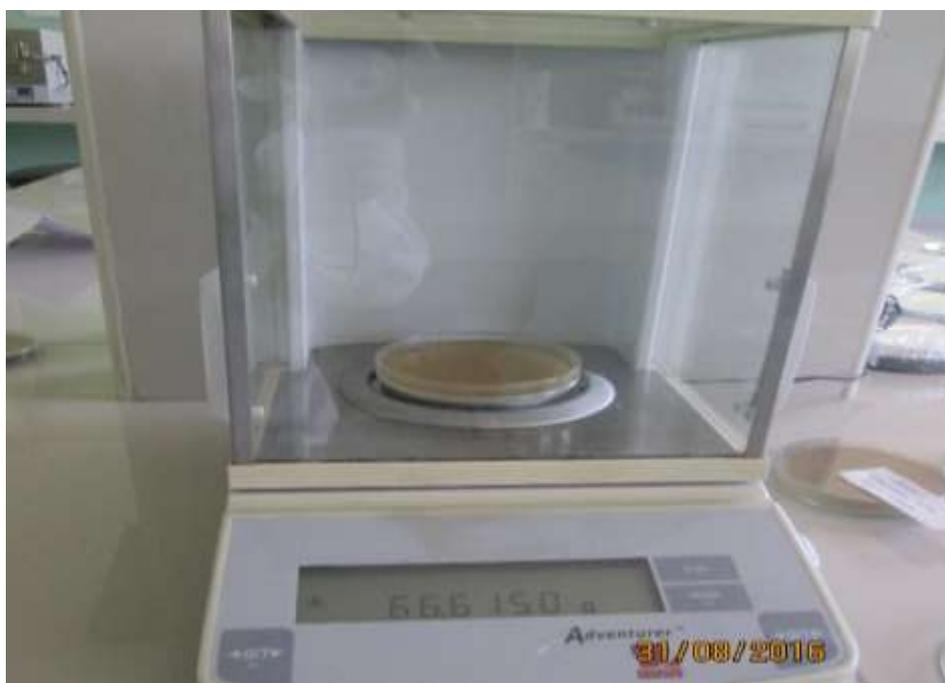
Figura 43. Pesado de las muestras de placas receptoras.
