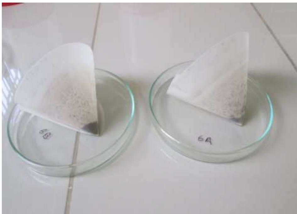
Figura 38. Ubicación de los filtros en las placas para ser colocadas en la estufa.
